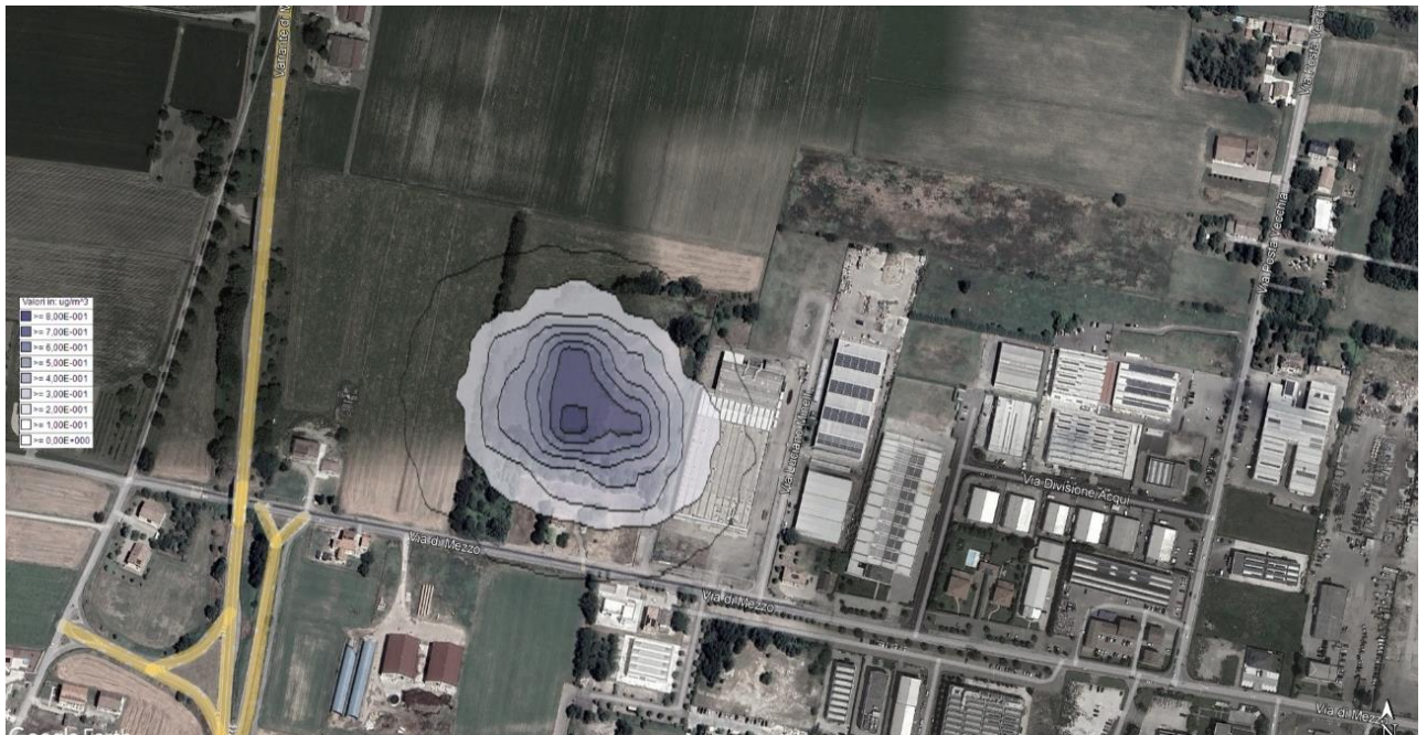
Figura 34 – Concentrazioni di PM 10 dovute alle emissioni dei mezzi d'opera sul sito di progetto
