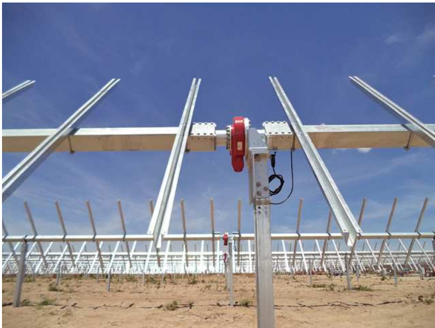
Figura 4 – Struttura dell'inseguitore solare monoassiale
