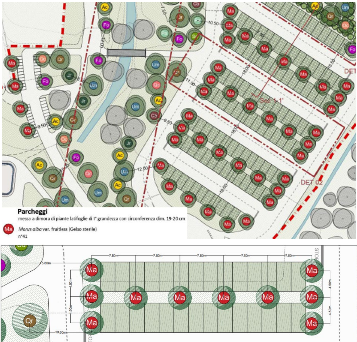
Figura 59 – Piantumazione di essenze arboree nell’area parcheggi [Fonte: PA.07_Planimetria generale opere a verde del progetto esecutivo “Rigenerazione e ampliamento impianto sportivo e campo cross Monte Coralli”]
