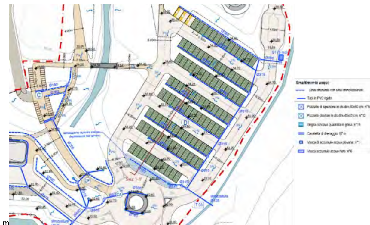
Figura 25 - Sistema di drenaggio dell'area parcheggio [Fonte: PA06a_Drenaggi e smaltimento acque meteoriche del progetto esecutivo “Rigenerazione e ampliamento impianto sportivo e campo cross Monte Coralli”]
