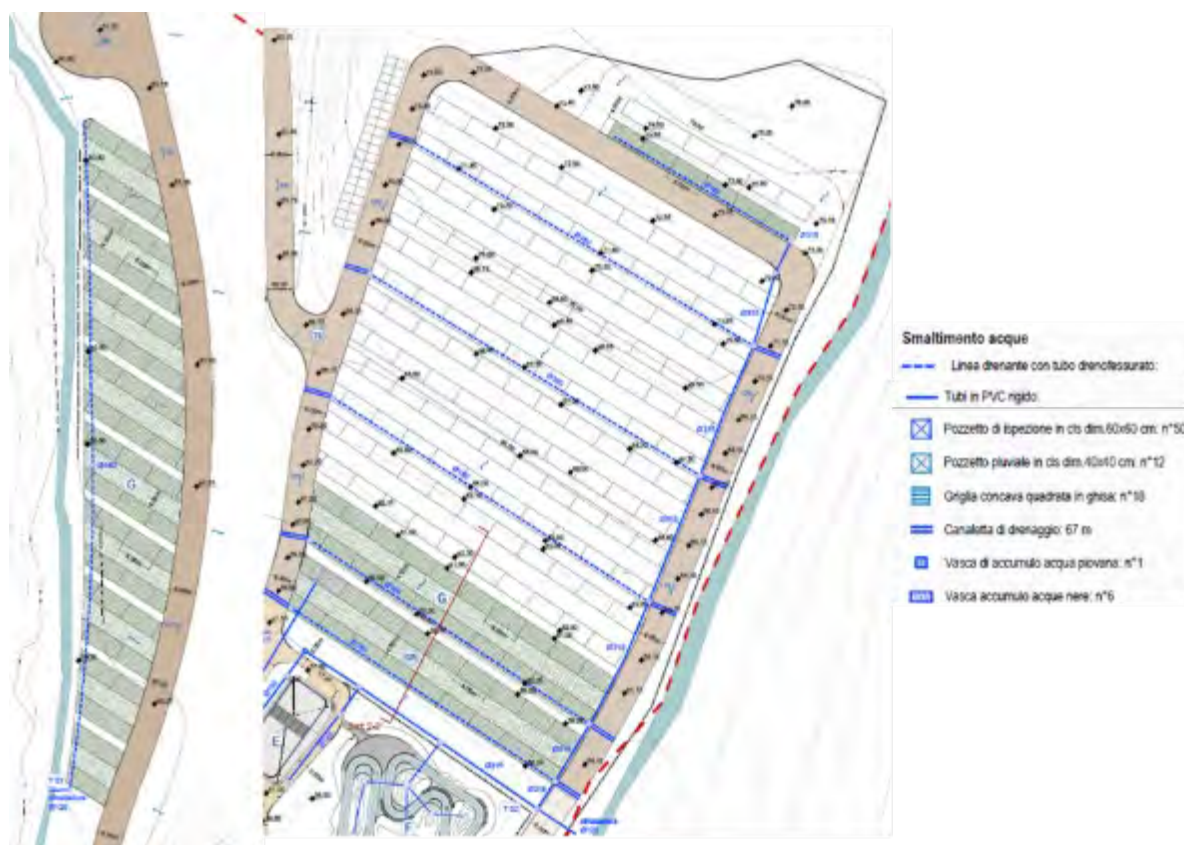
Figura 35 – Sistema di drenaggio dell'area paddock [Fonte: PA06a_Drenaggi e smaltimento acque meteoriche del progetto esecutivo “Rigenerazione e ampliamento impianto sportivo e campo cross Monte Coralli”]
