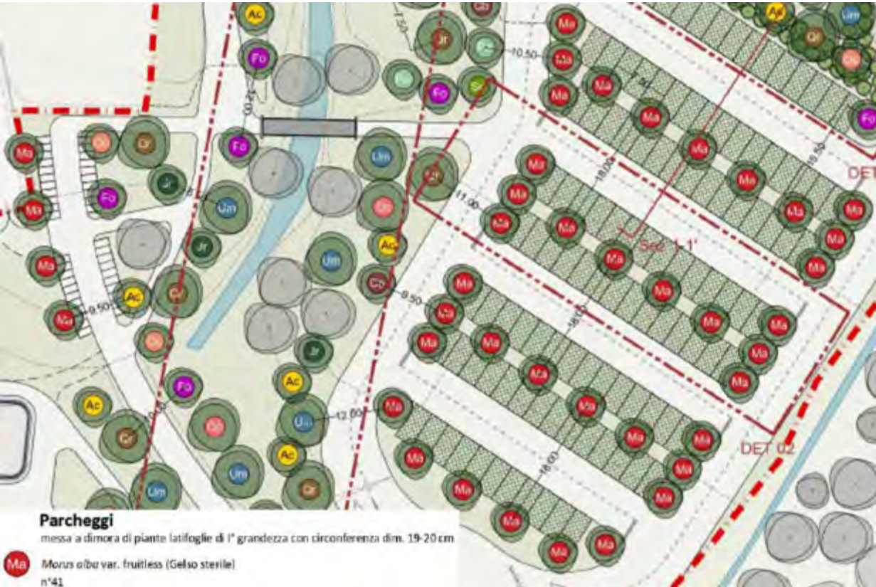
Figura 11 – Piantumazione di essenze arboree nell’area parcheggi [Fonte: PA.07_Planimetria generale opere a verde del progetto esecutivo “Rigenerazione e ampliamento impianto sportivo e campo cross Monte Coralli”]
