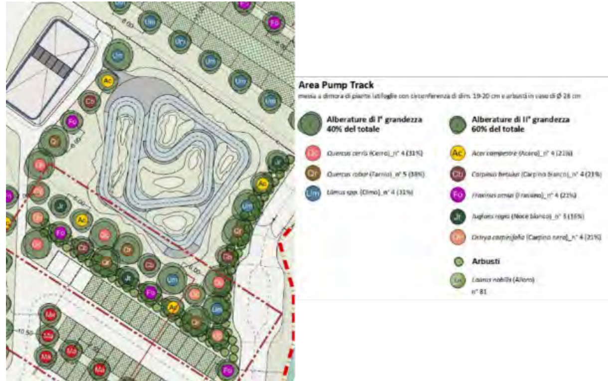
Figura 12 – Piantumazione essenze arboree nell’area pump track [Fonte: PA.07_Planimetria generale opere a verde del progetto esecutivo “Rigenerazione e ampliamento impianto sportivo e campo cross Monte Coralli”]
