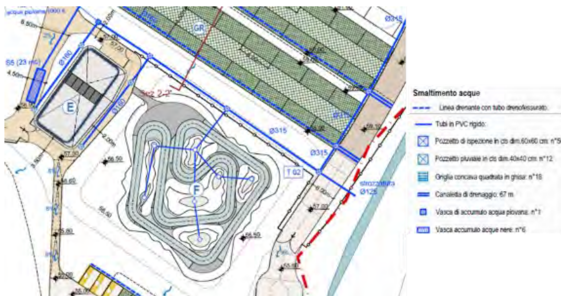
Figura 37 - Sistema di drenaggio dell'area pump track [Fonte: PA06a_Drenaggi e smaltimento acque meteoriche del progetto esecutivo “Rigenerazione e ampliamento impianto sportivo e campo cross Monte Coralli”]
