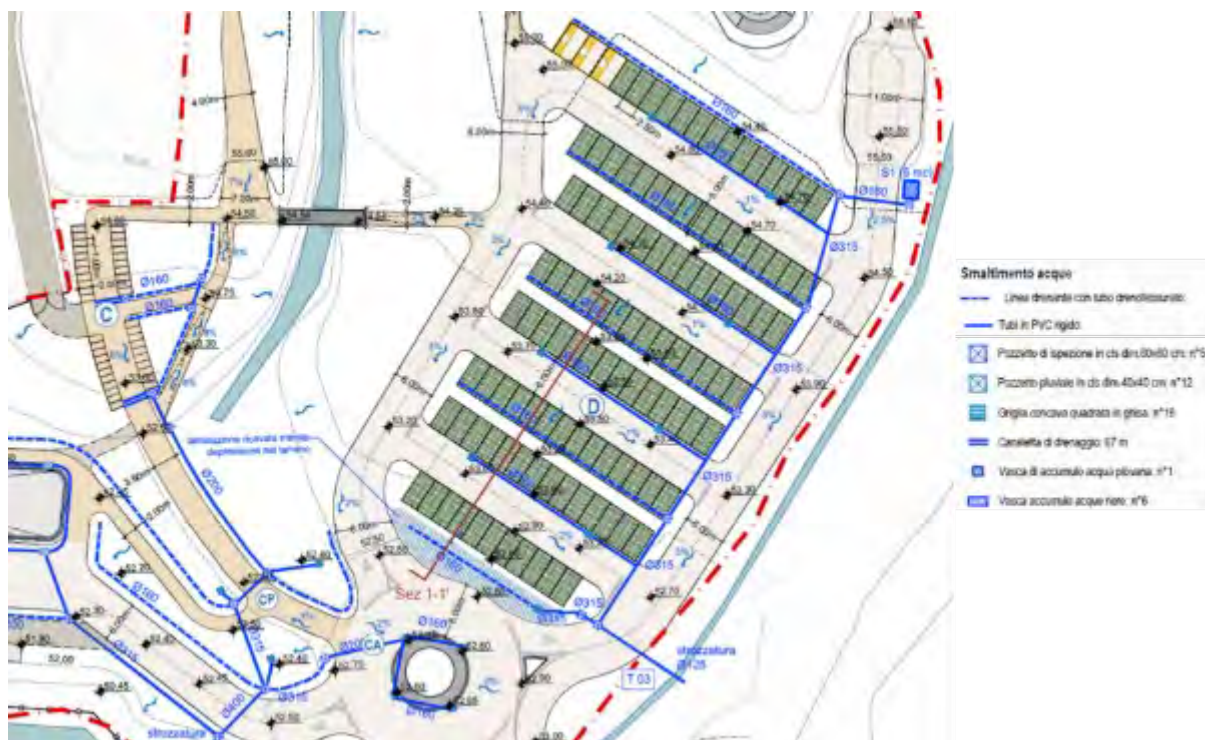
Figura 42 - Sistema di drenaggio dell'area parcheggi [Fonte: PA06a_Drenaggi e smaltimento acque meteoriche del progetto esecutivo “Rigenerazione e ampliamento impianto sportivo e campo cross Monte Coralli”]
