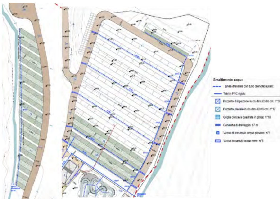
Figura 43 – Sistema di drenaggio dell’area paddock [Fonte: PA06a_Drenaggi e smaltimento acque meteoriche del progetto esecutivo “Rigenerazione e ampliamento impianto sportivo e campo cross Monte Coralli”]
