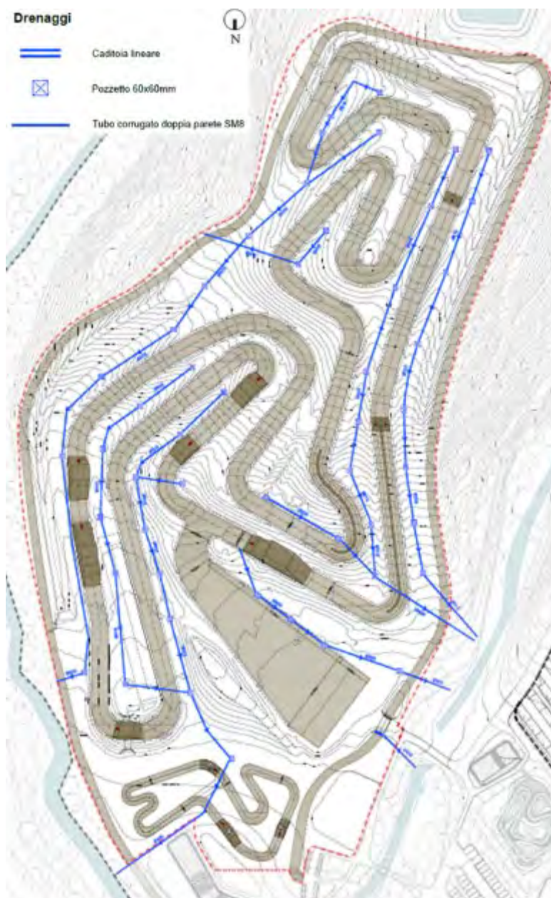
Figura 41 - Sistema di drenaggi della pista da cross [Fonte: T_AB_02_As built drenaggi del progetto “Pista da cross Monte Coralli”]
