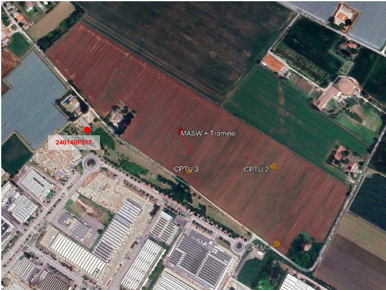
Figura 6-7 - Ubicazione delle indagini geognostiche in corrispondenza dell'impianto fotovoltaico
