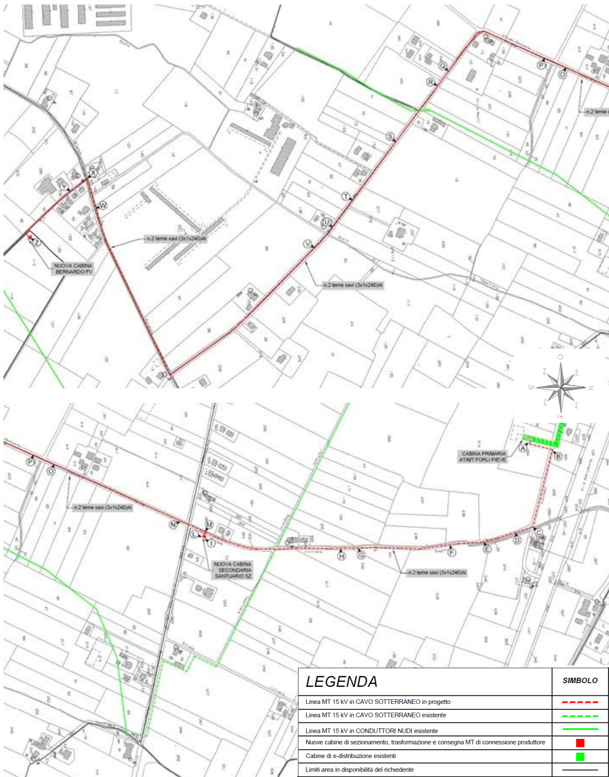
Figura 5.9 – Tracciato elettrodotto di connessione
