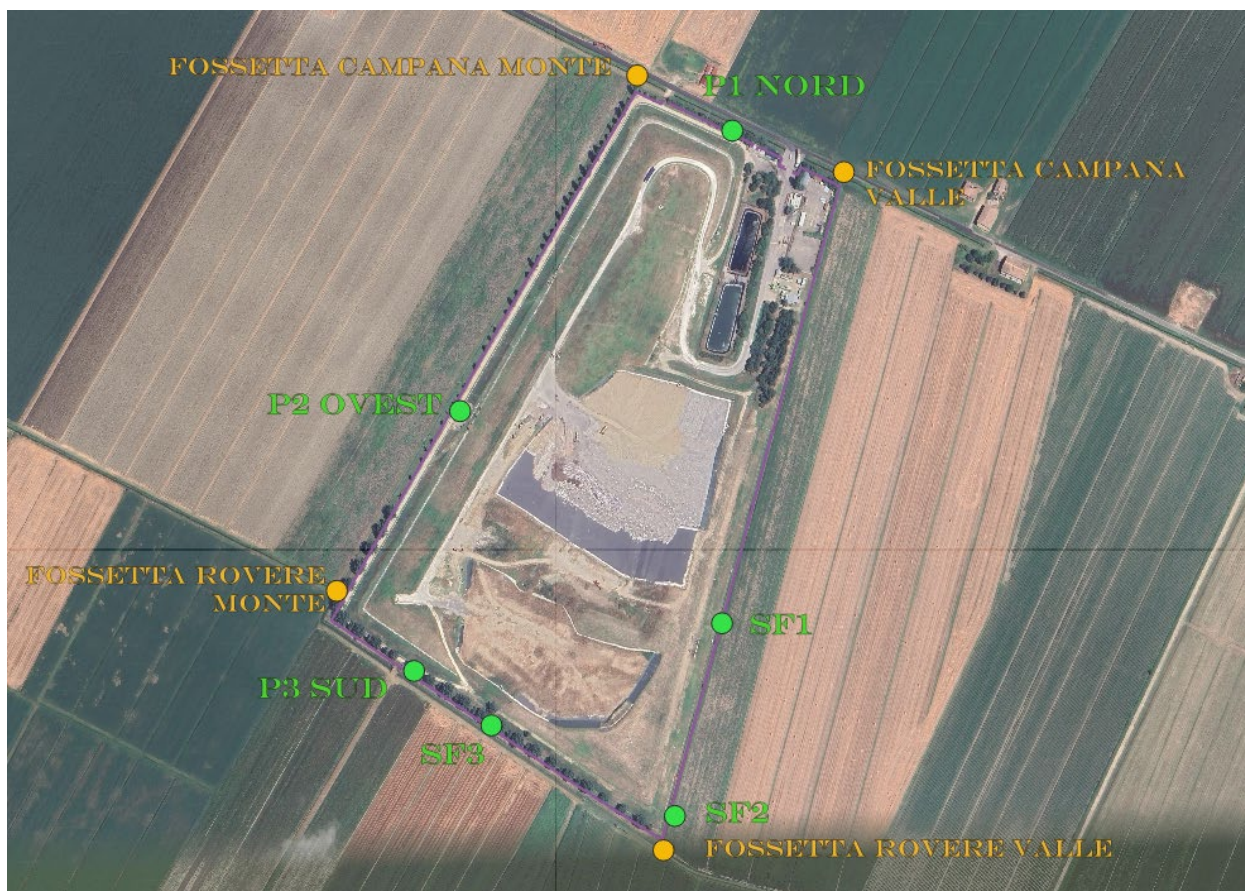
Figura 29 - Planimetria Discarica Aimag di Medolla con rete di monitoraggio delle acque superficiali e meteoriche di ruscellamento.
