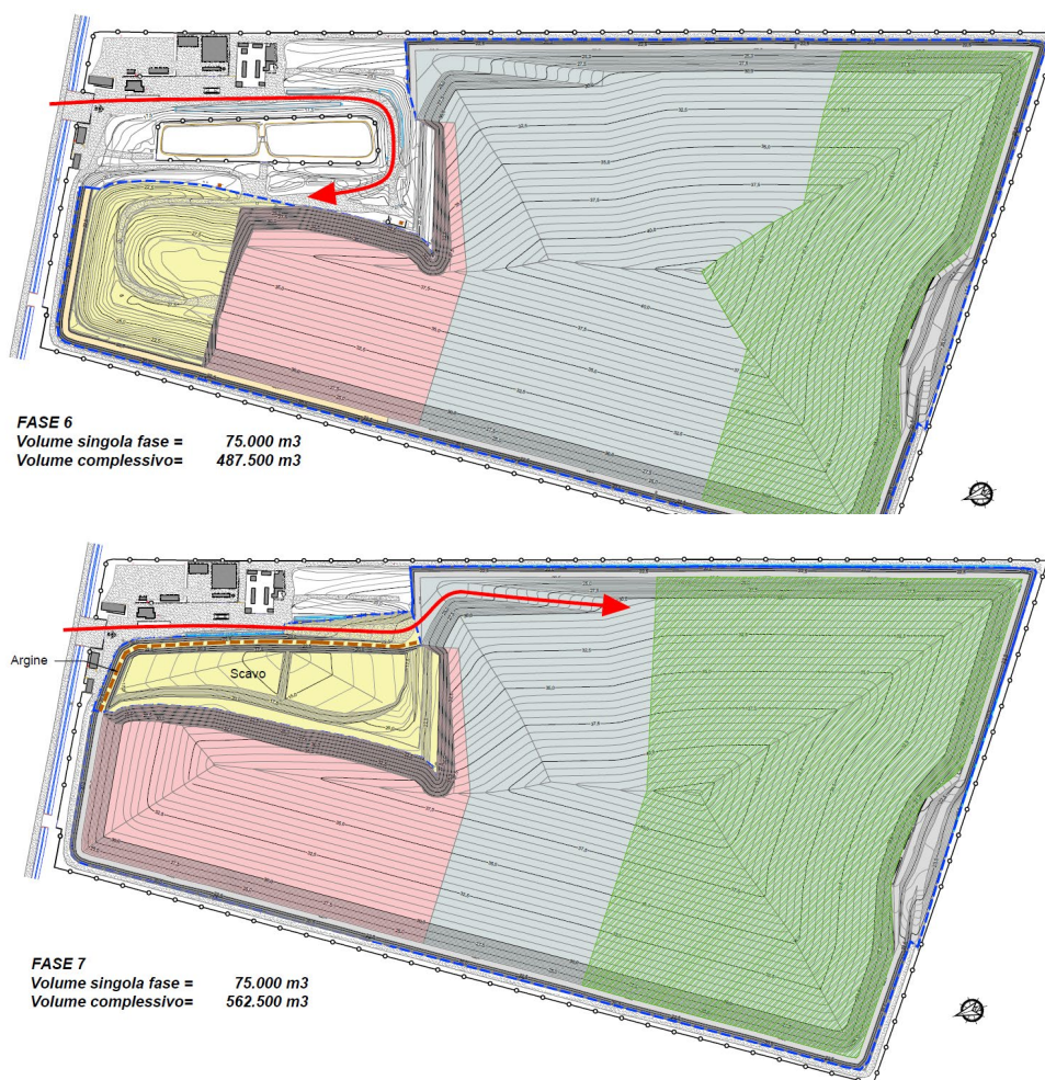
Figura 18 – Vasche esistenti di stoccaggio del percolato oggetto di dismissione nella fase 7 [stralcio tavola 3.4 di progetto]
