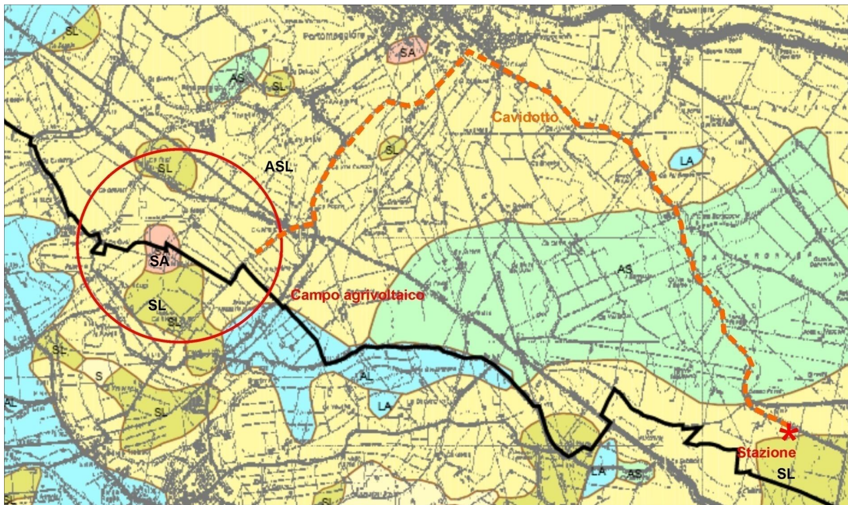
Figura 4. Estratto della Carta delle Litologie di Superficie del P.S.C., scala 1:50.000. ASL = argille sabbioso - limose, SL = sabbie limose, SA = sabbie argillose
