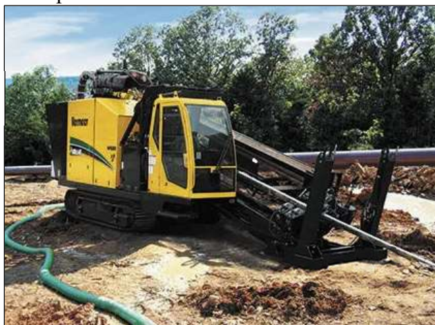
Figura 5-2 Esempio di macchina perforatrice T.O.C.
