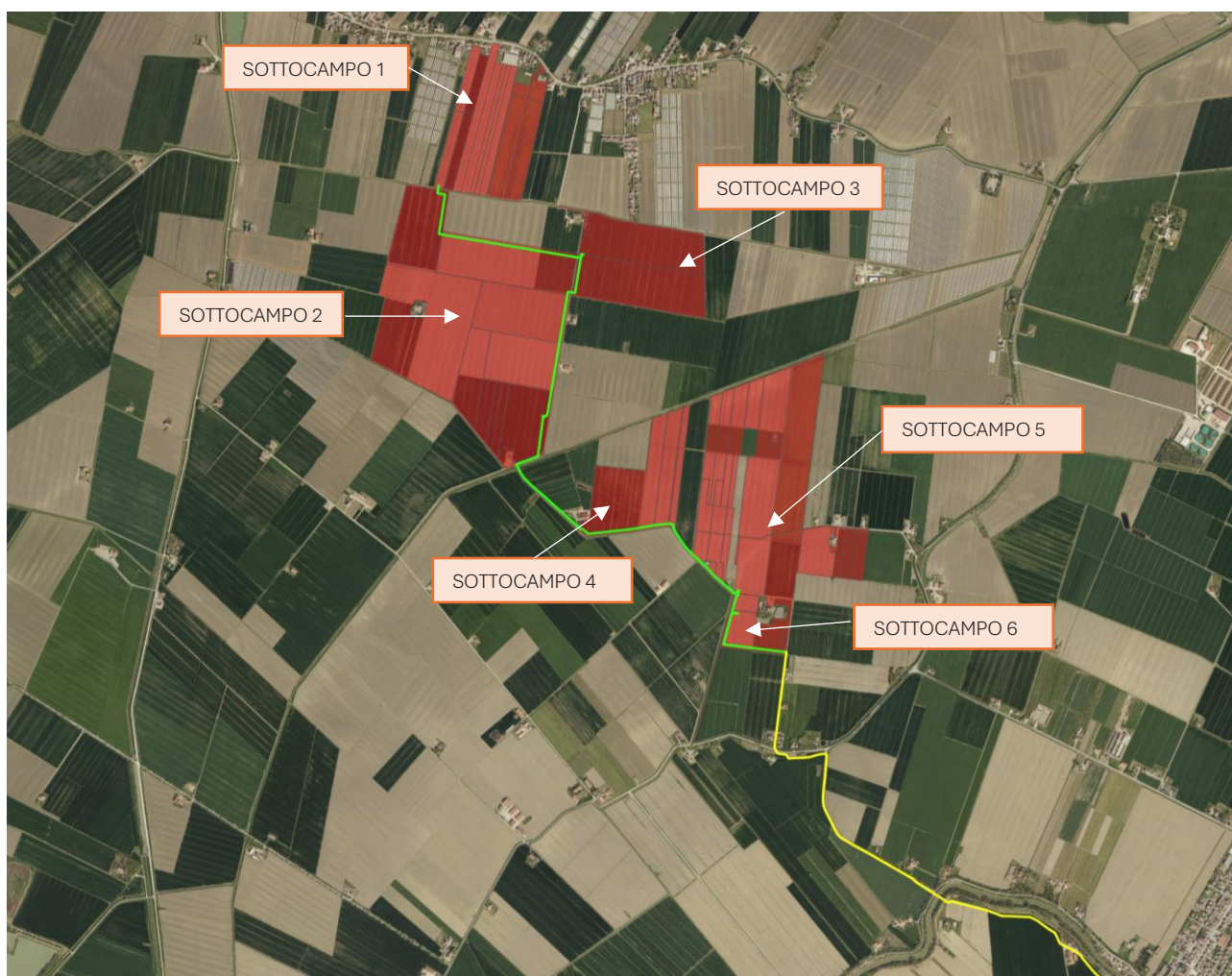
Figura 1: Tracciato del cavidotto di collegamento tra i sottocampi dell'impianto (verde) e tracciato del cavidotto dal sottocampo 6 alla SE Bondeno (giallo)
