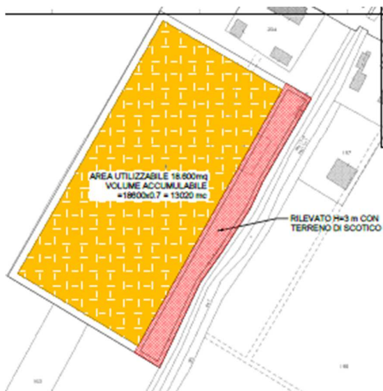
Fig. 22 rilevato con terreno di scotico alto 3-4 m a protezione da rumore e polveri per la parte a sud della SP 21
