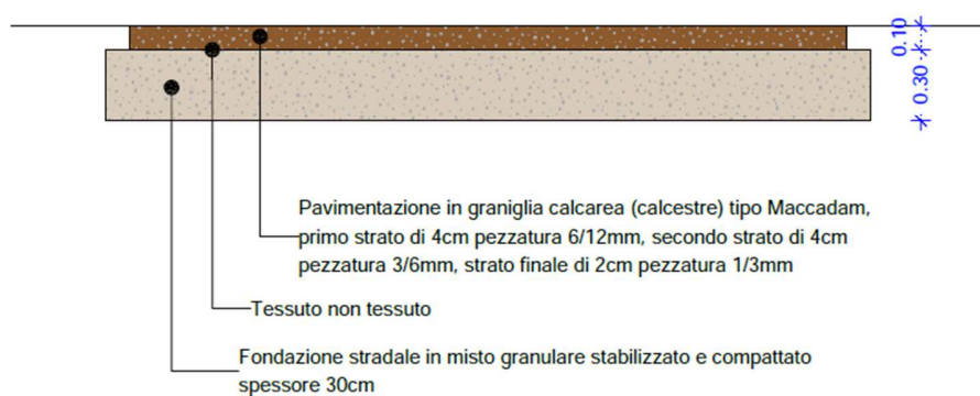
Fig. 16: stralcio elab. PR430_ER-URVI-001198_PFTE_EG009: dettaglio percorso in calcestre
