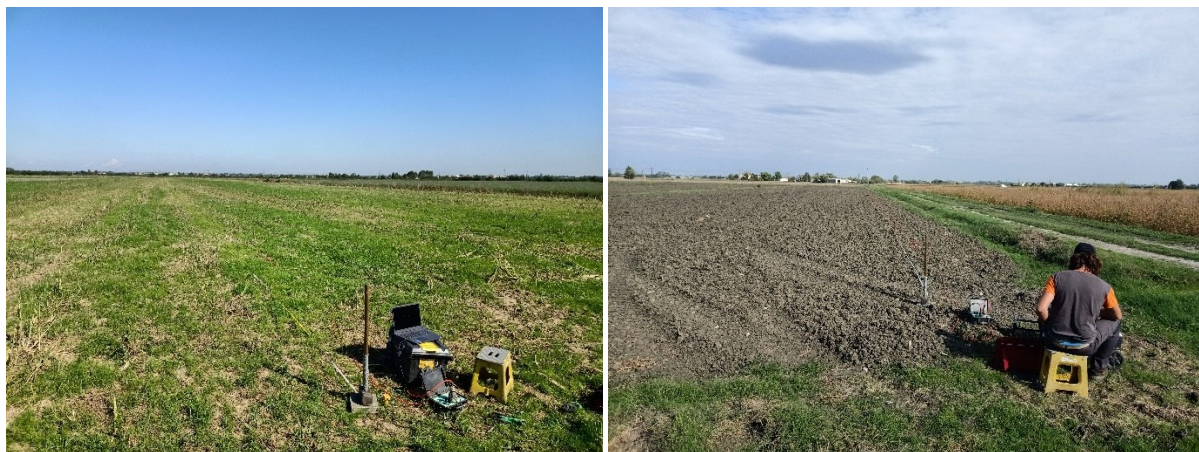
Figura 15: Stendimenti sismici per indagine MASW n° 1 e n°2.
