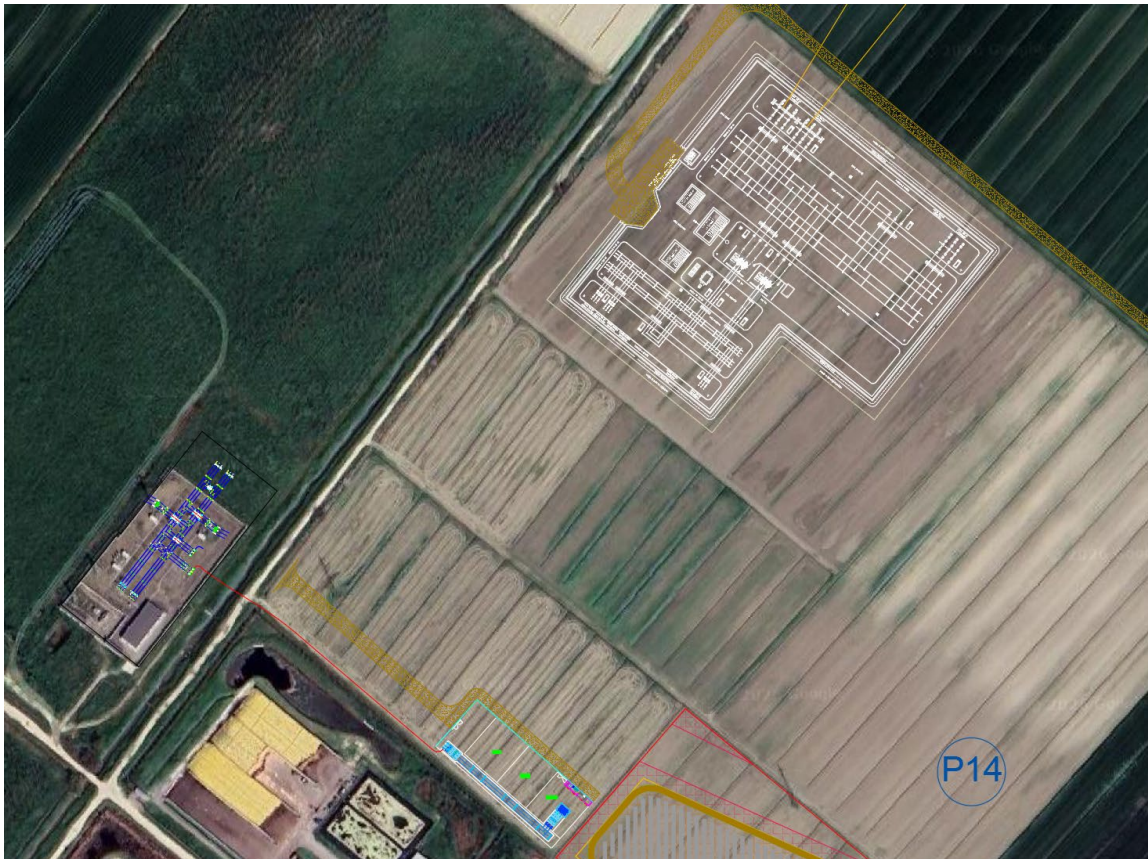
Figura 19 – Particolare nuova stazione SE 380 kV e ampliamento stazione 132 kV Massa Finalese
