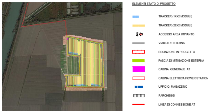
Figura 109 – Layout impianto Bondeno
