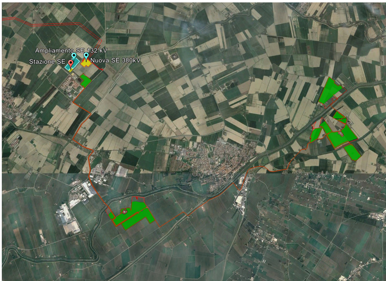
Figura 4 - Tracciato cavidotto MT verso SE
