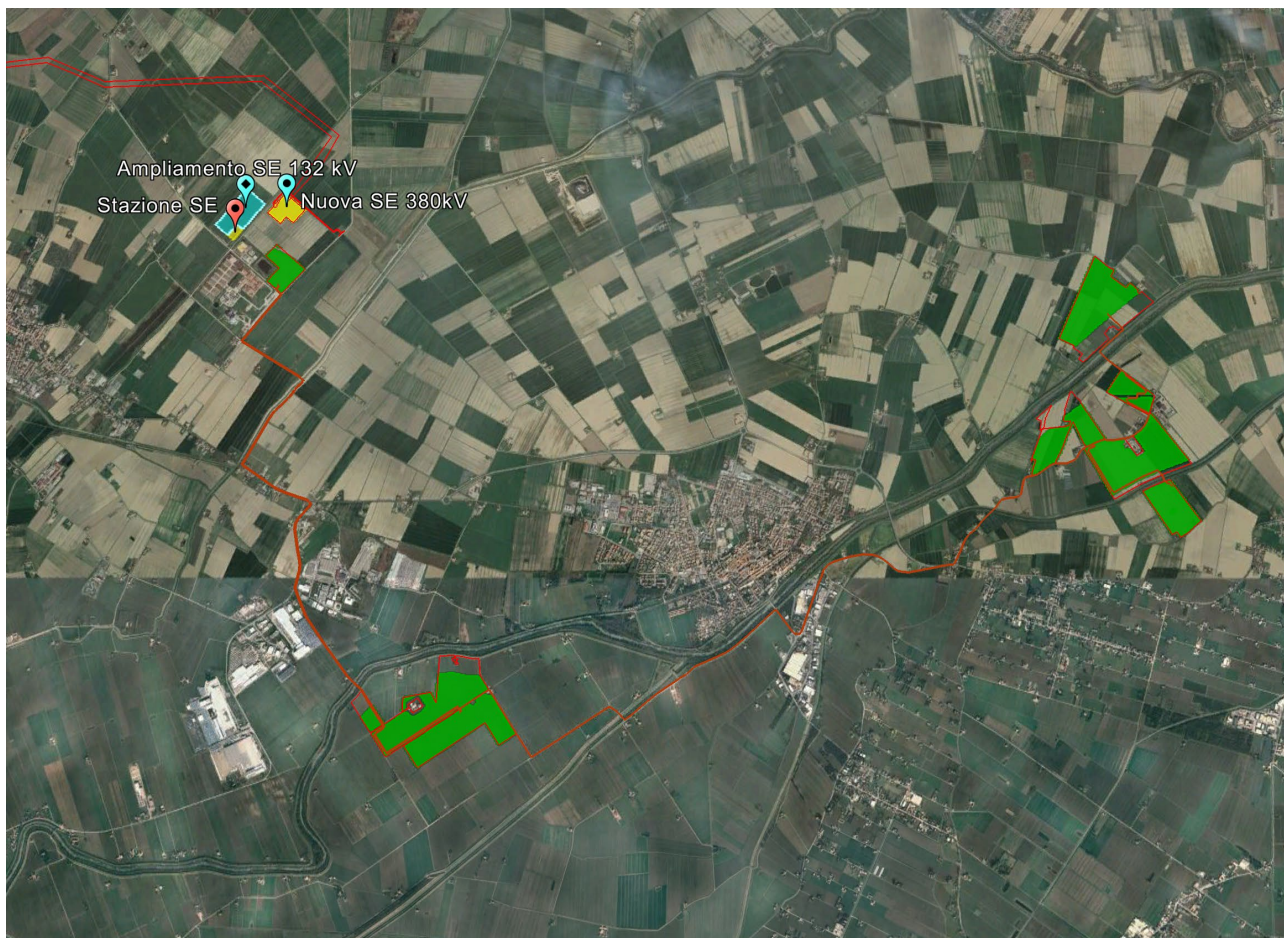
Figura 2 - Tracciato cavidotto MT verso SE
