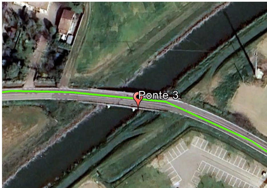
Figura 42 – Interferenza "Ponte 3" tra cavidotto tra R2 e R3 e canale di superficie
