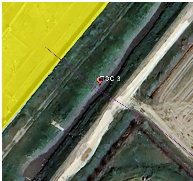
Figura 55 - Interferenza “TOC 3” tra canale di superficie e cavidotto AT verso SE
