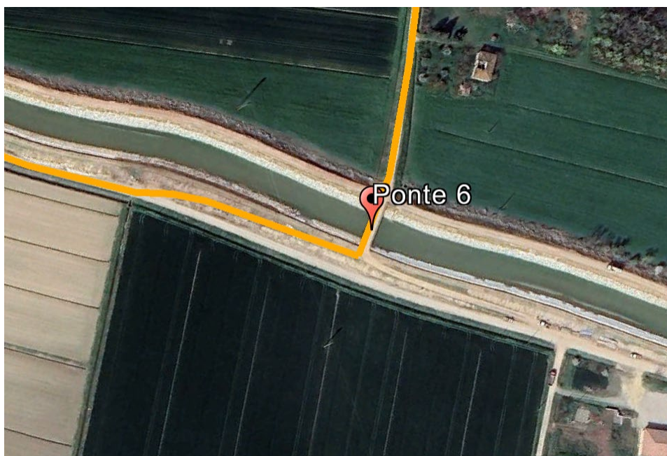
Figura 48 – Interferenza "Ponte 6" tra cavidotto tra R3 e RT e canale di superficie
