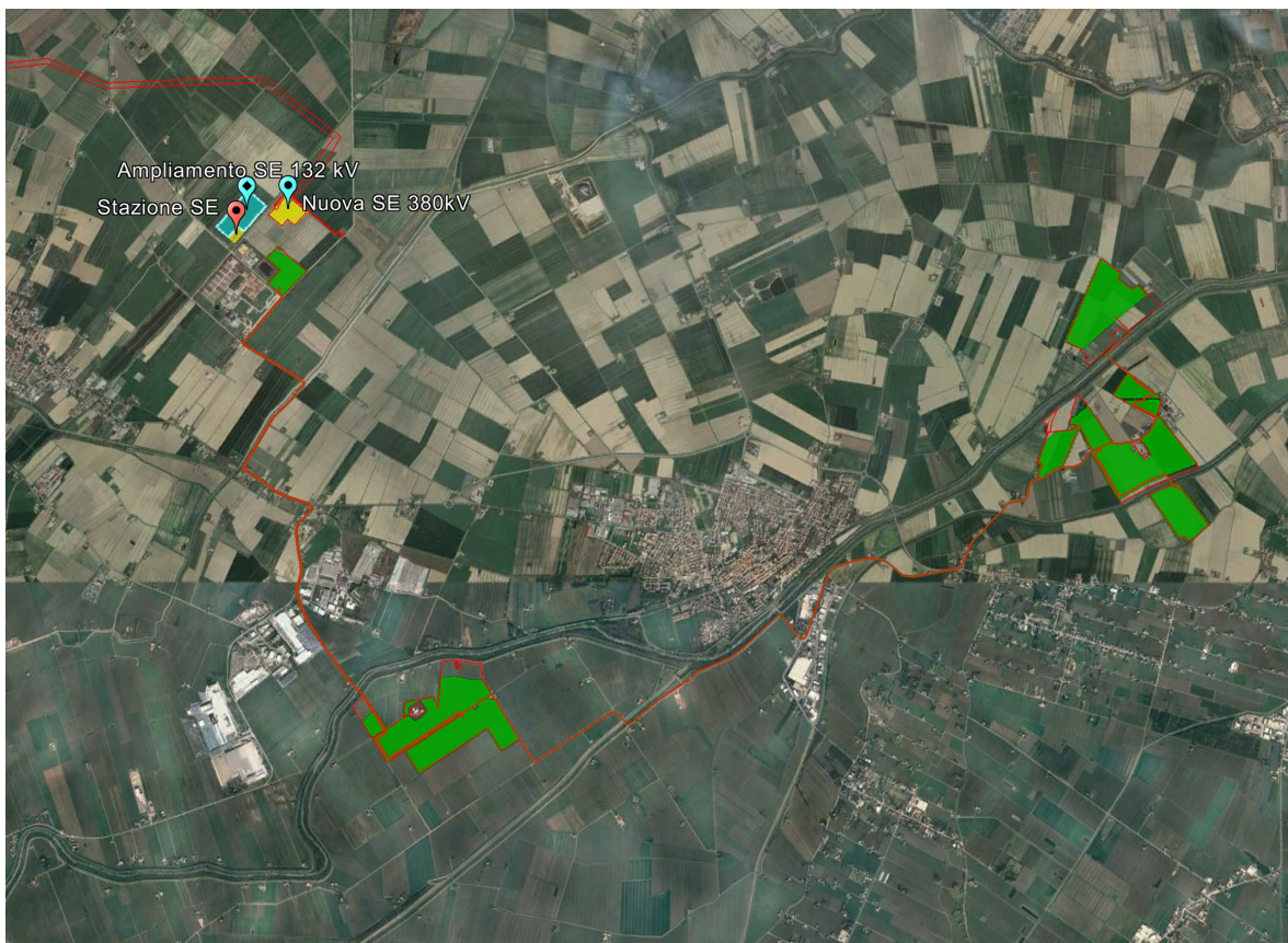
Figura 3 – Tracciato cavidotto MT complessivo verso SE
