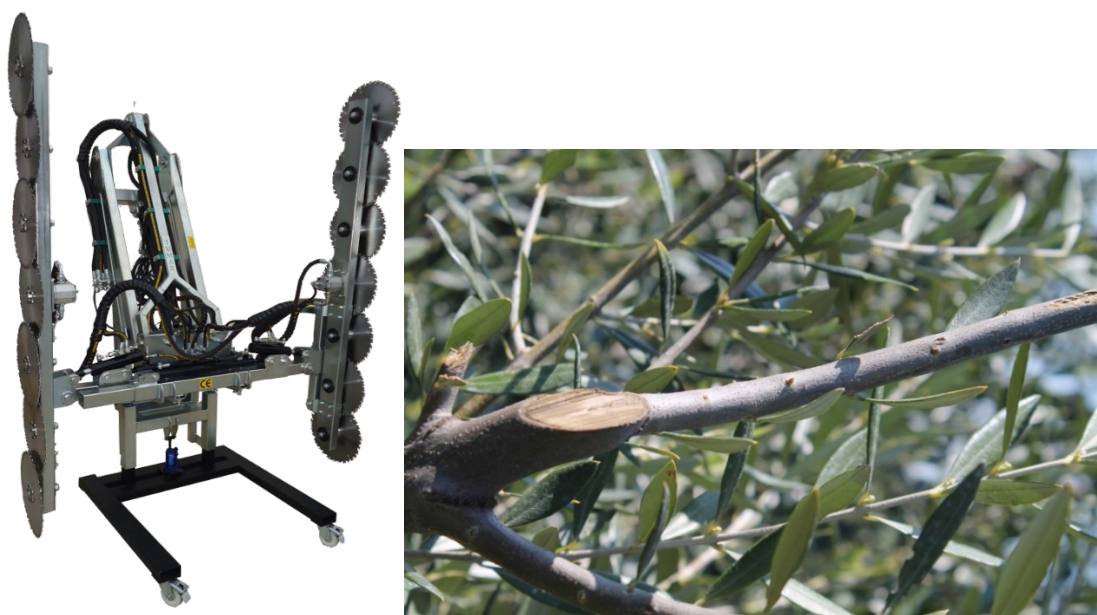
Figura 54 - Dischiera per la esecuzione di topping ed heading laterale. Mod. Duplex (sinistra). Particolare di taglio (destra)
