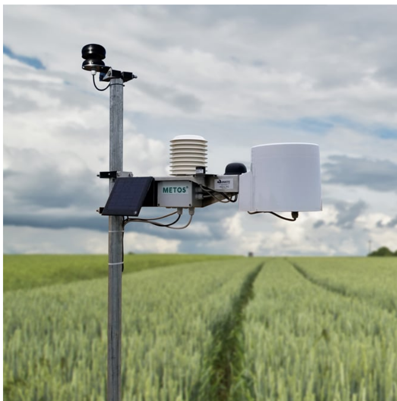
Figura 37 – Stazione meteo con pluviometro,
