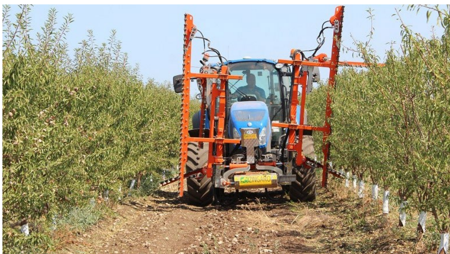
Figura 25 - Potatura meccanizzata in un mandorleto superintensivo (Fruit journal)
