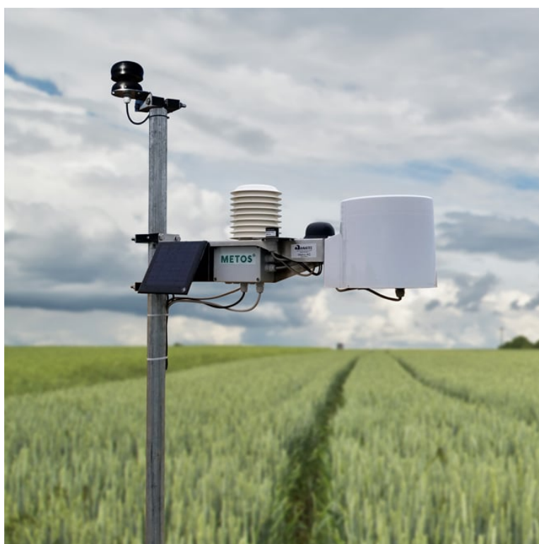
Figura 95 – Stazione meteo con pluviometro,
