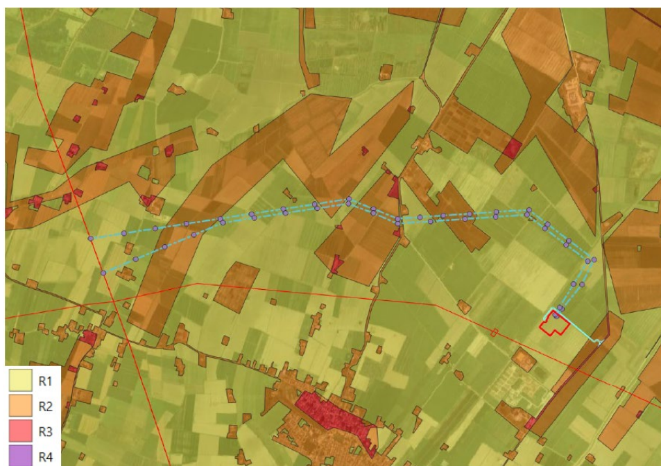
Figura 38 - Elettrodotto 380 kV, soluzione A, tralicci
