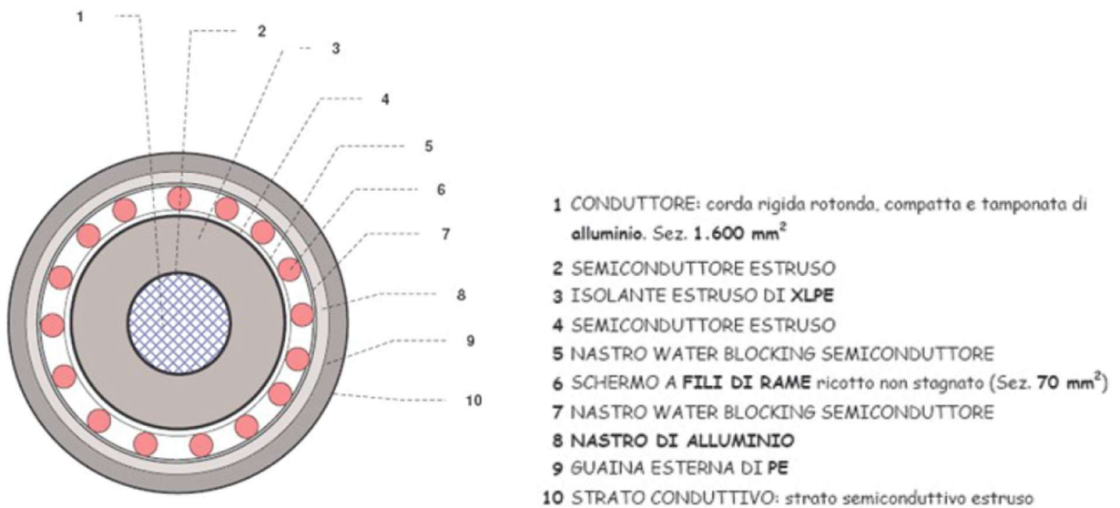
Figura 3 – Particolare costruttivo cavo AT 220 kV
