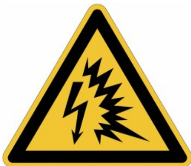
Figura 11: Segnaletica tipo da posizionare all'ingresso dei locali ESS. (Fonte: ENEA - "Rischi connessi con lo stoccaggio di sistemi di accumulo Litio-ione" e NFPA 855)
