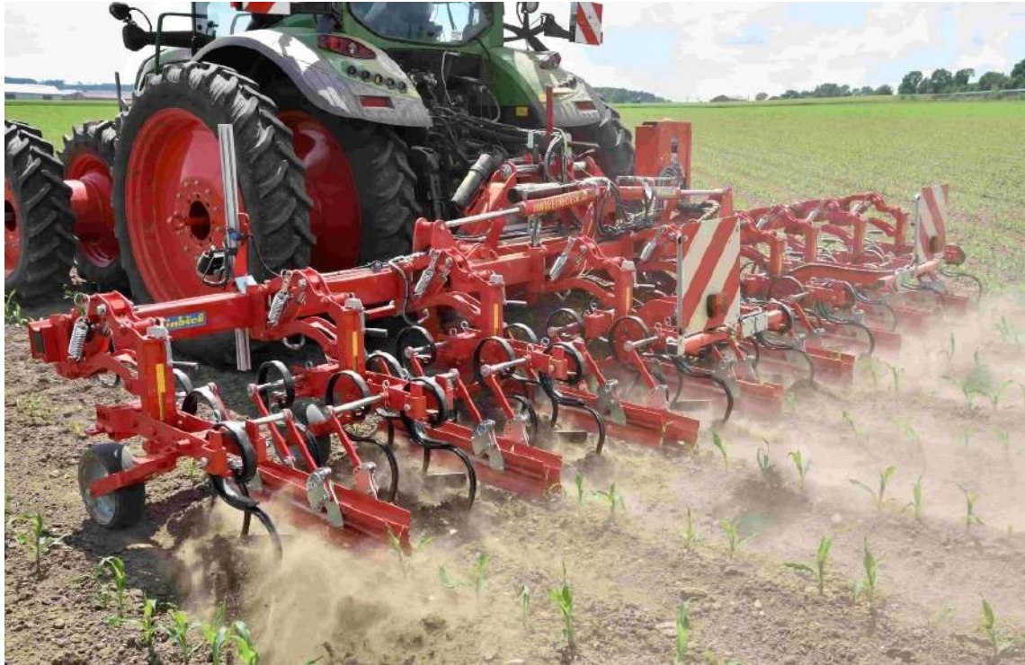
Figura 6-12 – Sarchiatrice con denti molleggiati (fonte: einboeck.at)
