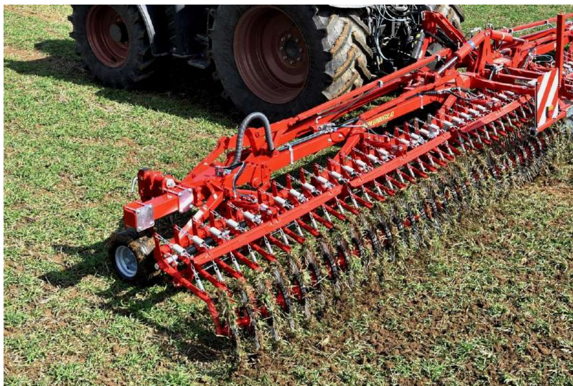
Figura 6-13 – Erpice strigliatore su infestanti (fonte: einboeck.at)
