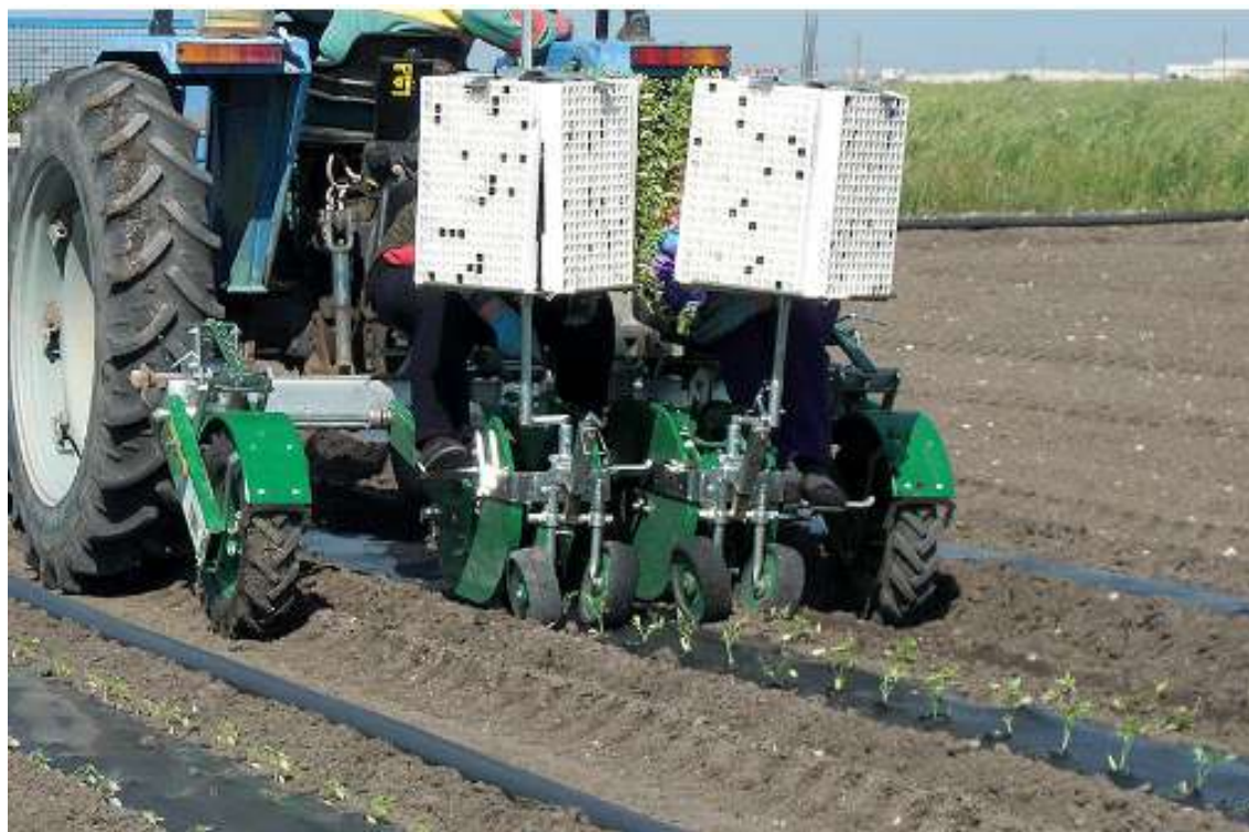
Figura 6-14 - Trapiantatrice portata in azione su terreno pacciamato
