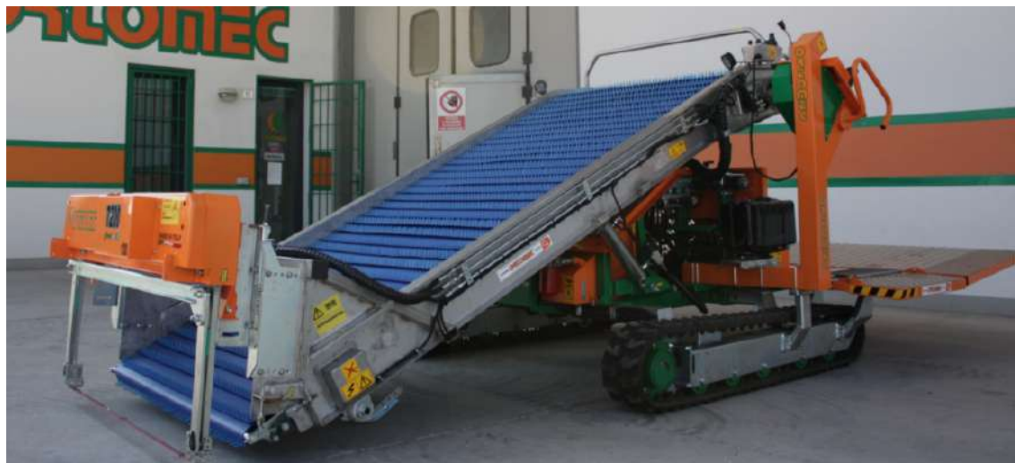
Figura 6-18 - Macchina semovente per raccolta delle orticole da taglio
