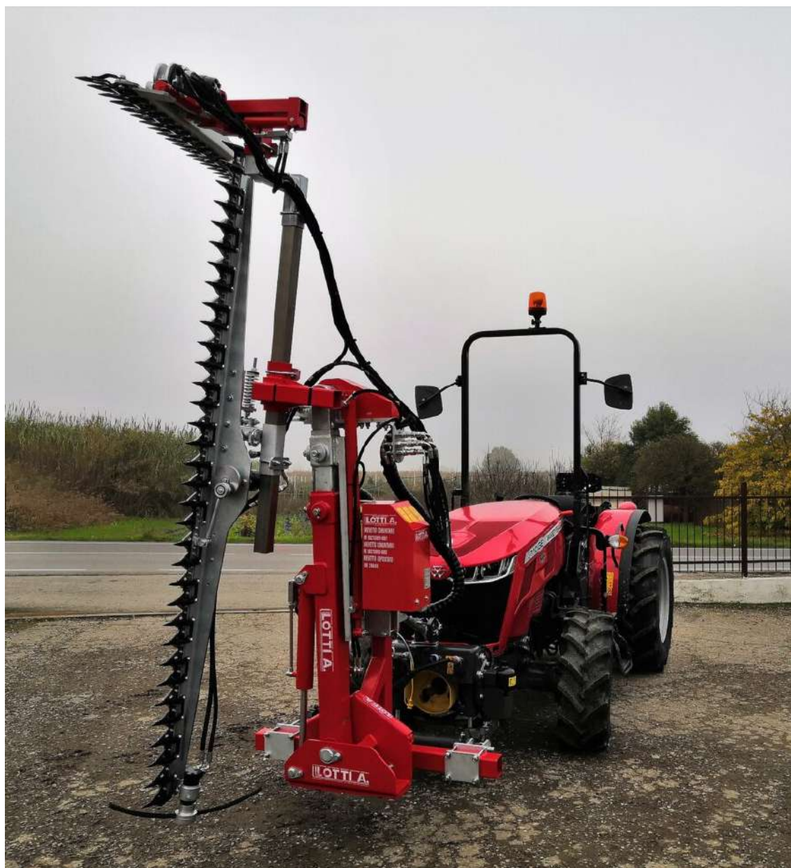
Figura 8-4 – Potatrice meccanica frontale a doppia barra (fonte: Lotti Antonio tecnologie per l'agricoltura)
