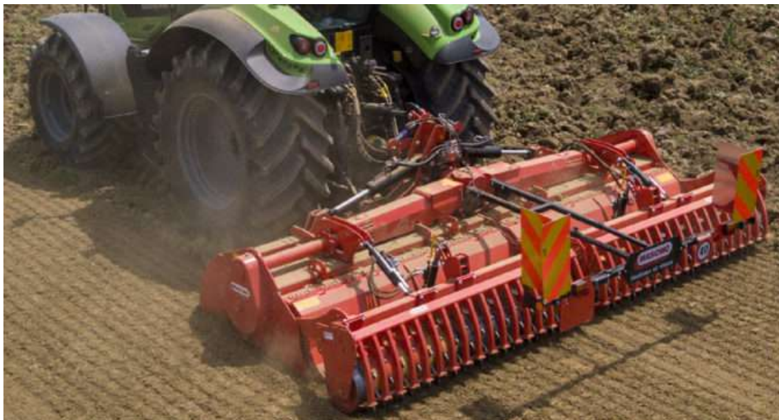
Figura 6-11 – Fresa o zappatrice rotativa
