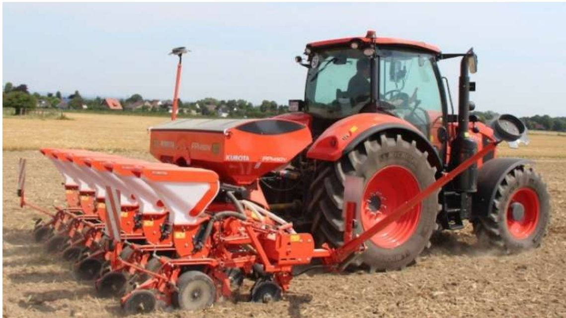
Figura 6-15 – Seminatrice di precisione (fonte: agronotizie)
