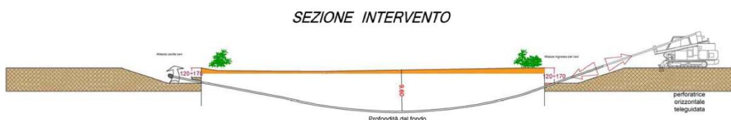
Figura 6.1 – Layout tipico dell'attraversamento dei cavidotti con sistema TOC
