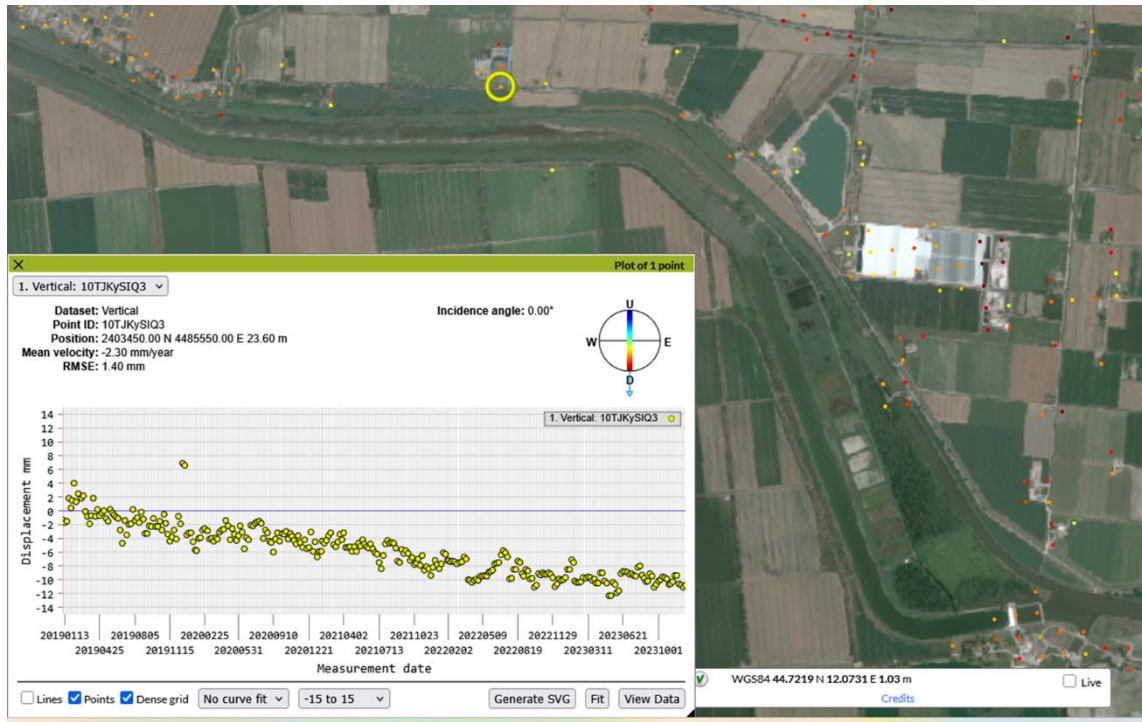
Figura 36 Spostamento del suolo nel periodo 2019-2023 in prossimità dell'area SG1, sulla base di dati Sentinel elaborati dal progetto Copernicus. Il tasso medio di subsidenza è pari a 2.3mm/anno.
