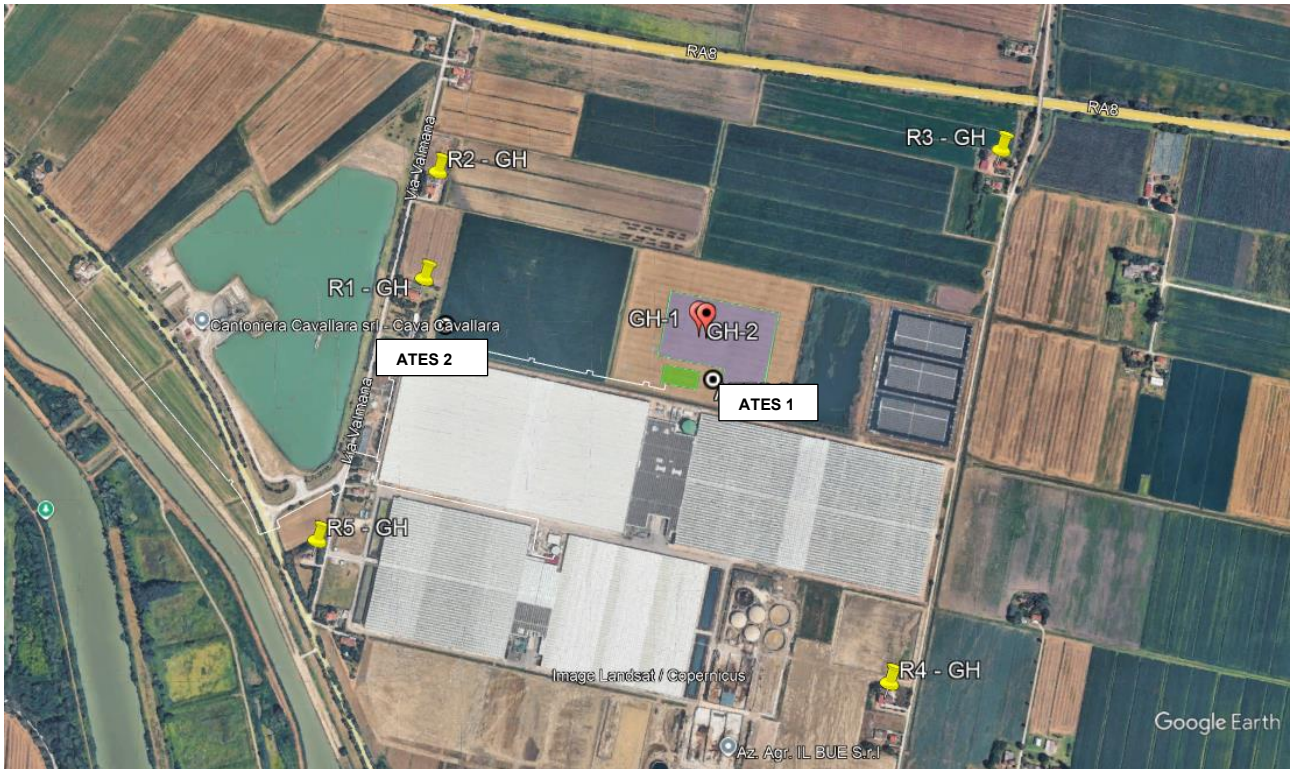
Figura 62 – Ricettori sensibili R1-GH, R2-GH, R3-GH, R4-GH ed R5-GH presso il sito Green House relativo all’insediamento della Platea GH, dei Pozzi ATES e dell’Energy Building
