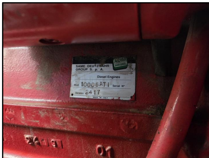
Figura 9- Dettaglio targhetta motore diesel che alimenta la presso cesoia
