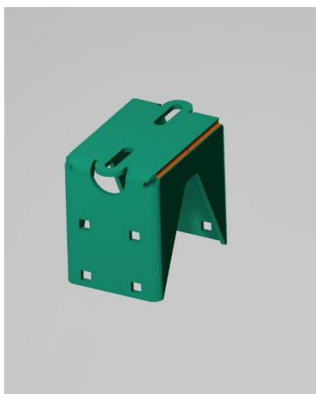
Figure 10-Dettaglio costruttivo della testa palo.
