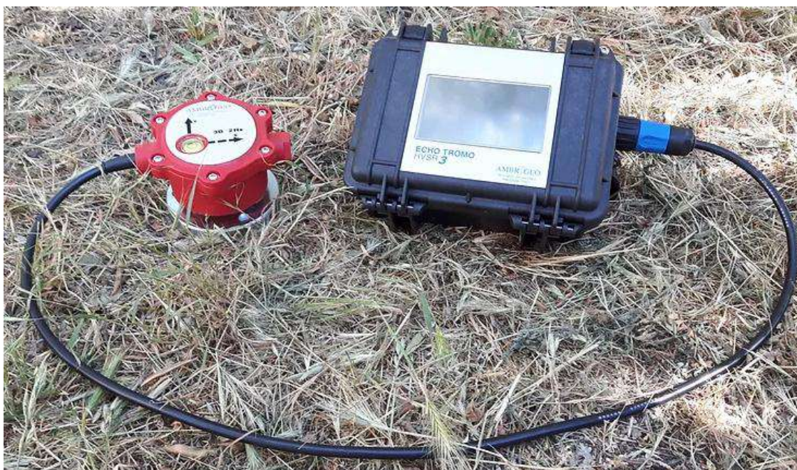
Sismografo Echo Tromo HVSR 3.
