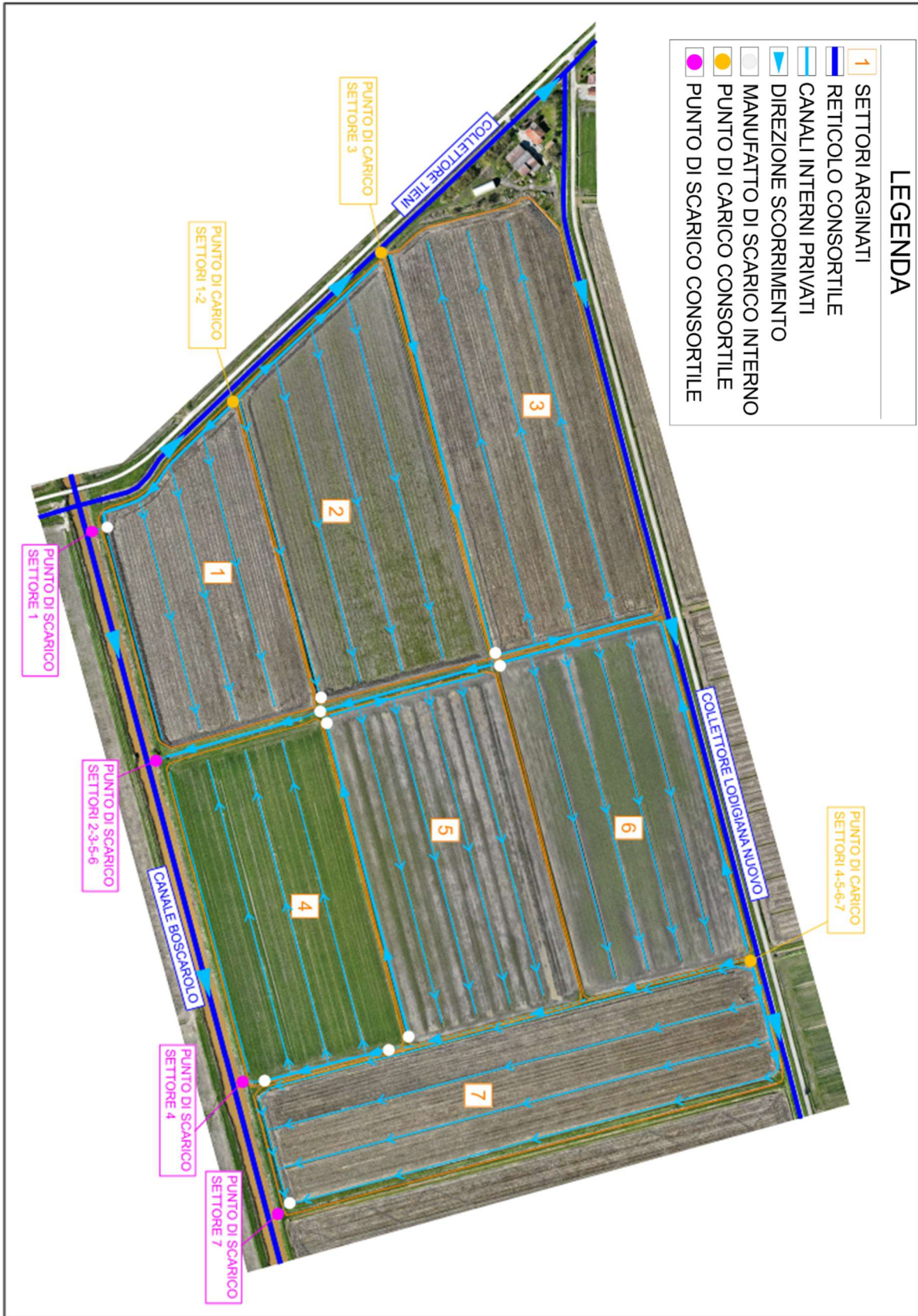
Figura 9. Schema di irrigazione allo stato di fatto
