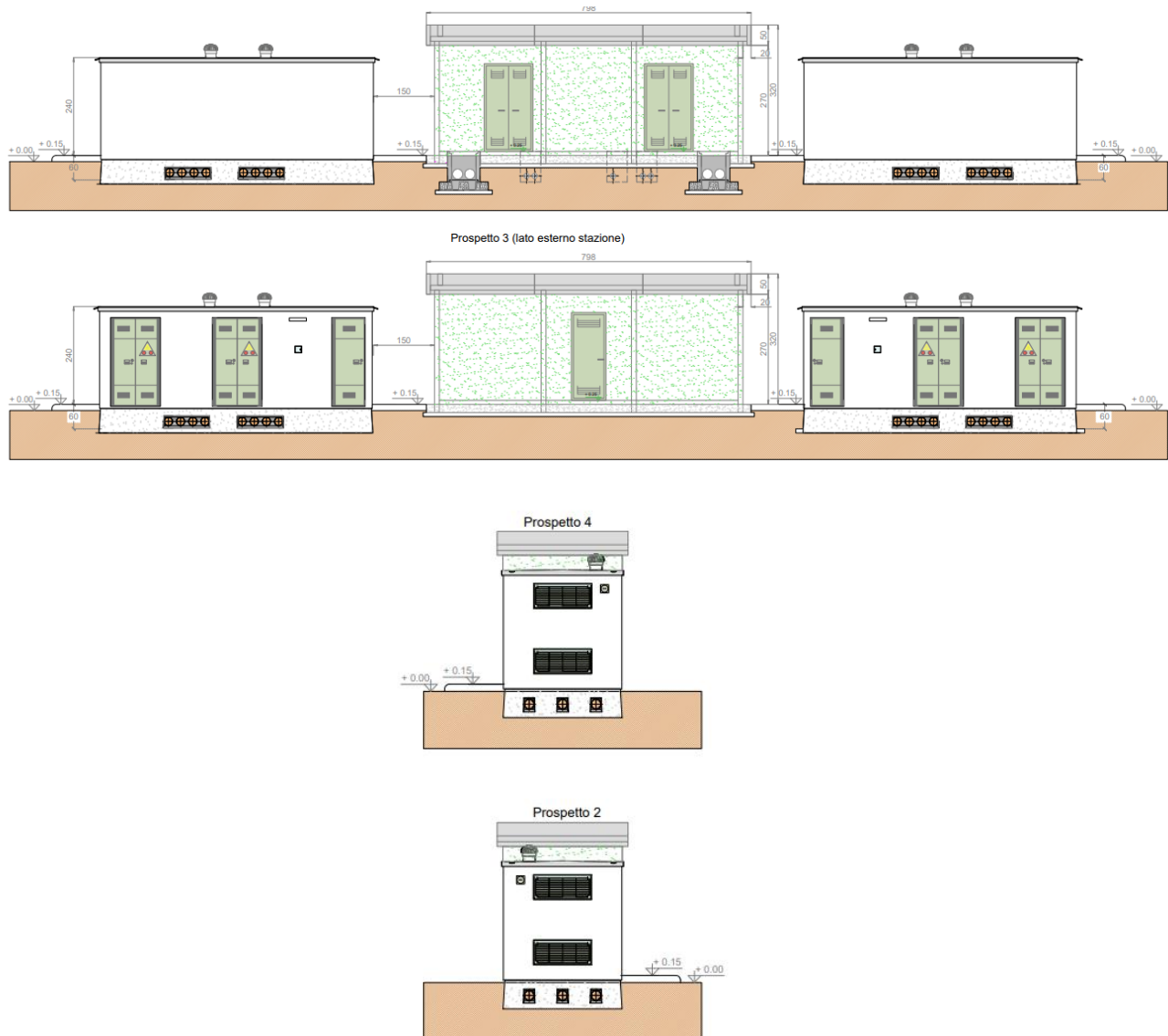
Figura 12 – Edificio di consegna MT/TLC: pianta e prospetti (stralcio Tav.040.25.01.W.14)
