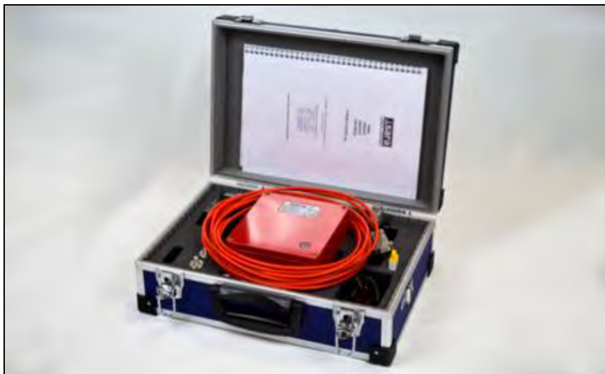
Fig. 1: Strumentazione utilizzata per le misure di microtremore (HVSr)
