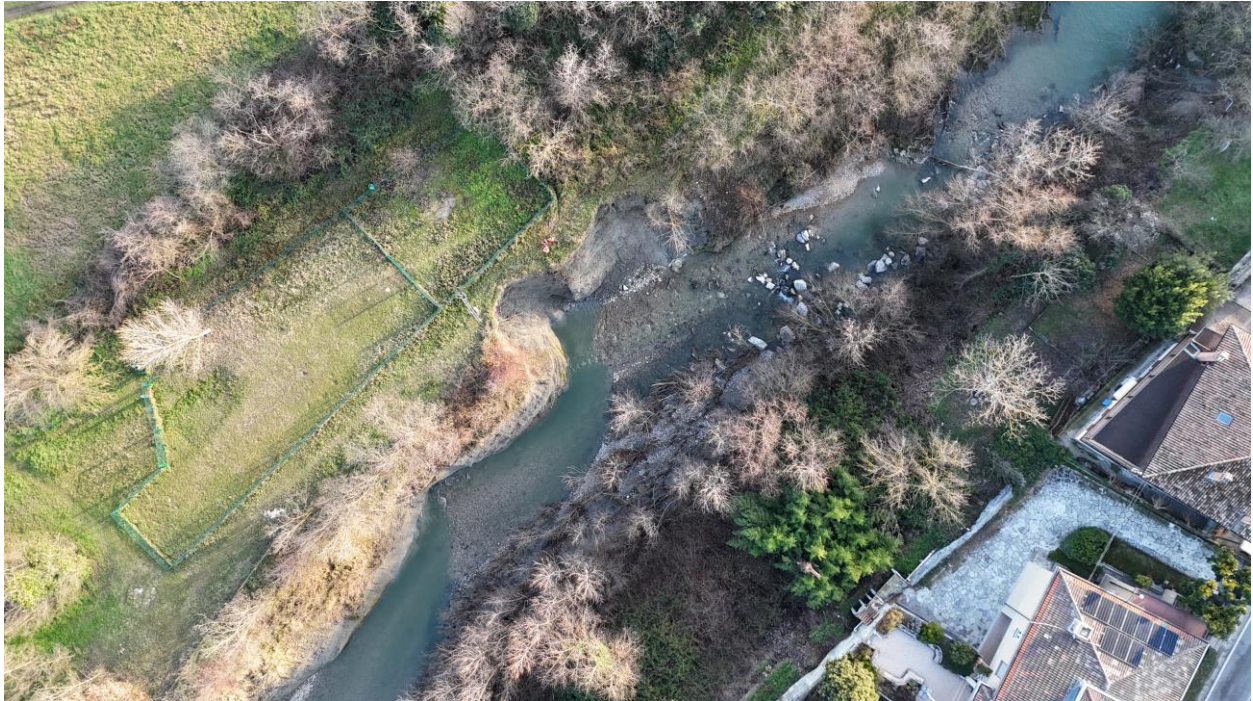
Vista dal drone di parte del tratto in oggetto con evidenza delle aree inerbite, porzioni franose e presenza di edifici adiacenti in sponda sinistra
