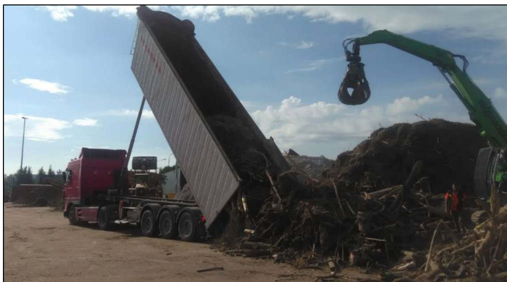
Figura 10 - Esempio di rifiuto conferito con il 200138 (legno da mareggiate) utilizzabile a fini energetici come biomassa combustibile
