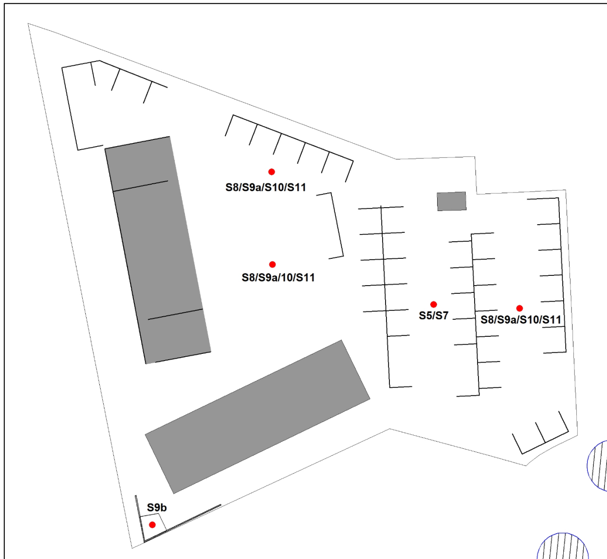
Figura 15: Planimetria dell'impianto in esame con ubicazione delle sorgenti sonore durante il periodo notturno - Scenario di progetto
