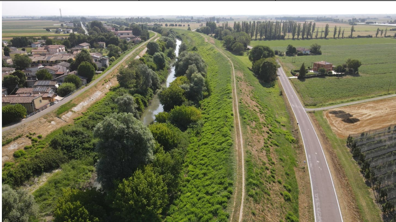
Figura 18: Foto Drone (120) – Vista del Fiume Panaro (orientata verso est), con evidenza dello stato fortemente vegetato delle aree golenali.
