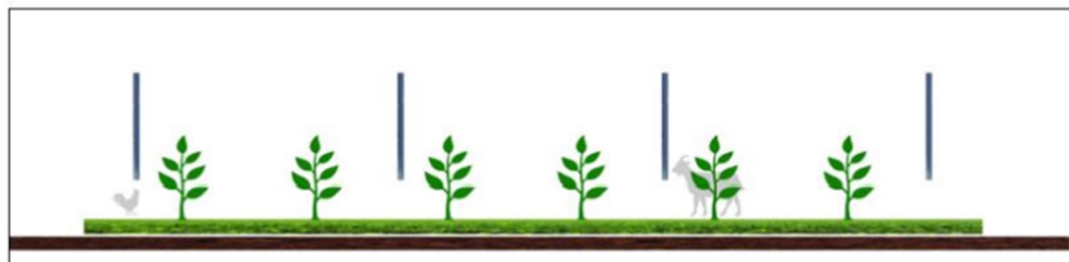
Figura 3. TIPO3: sistema agrivoltaico in cui i moduli fotovoltaici sono disposti verticalmente. La coltivazione avviene tra le file dei moduli fotovoltaici, l'altezza minima dei moduli da terra influenza il possibile passaggio degli animali.
