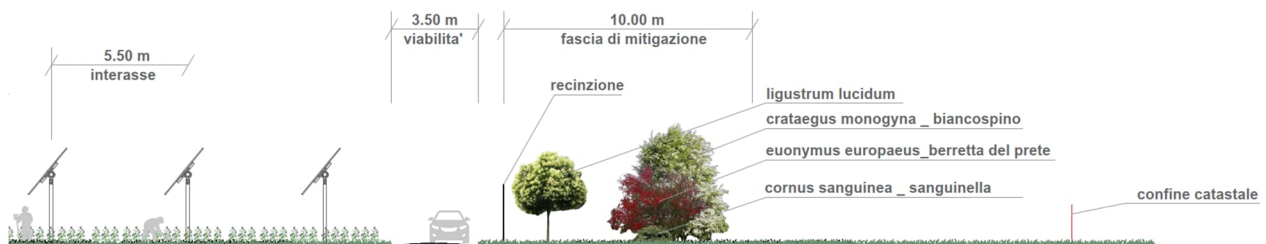
Figura 55. Sezione della fascia di mitigazione normale costituita da due file di arbusti melliferi.
