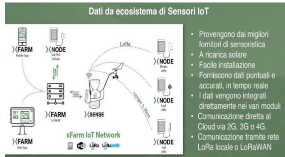
Immagine 23: schema di funzionamento del sistema IoT per la stazione meteo e gli accessori
