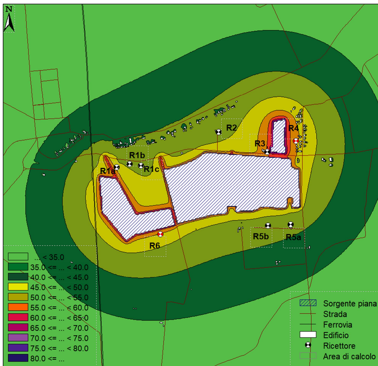
Fig.17: Mappatura Acustica in fase di Costruzione impianto Agrivoltaico
