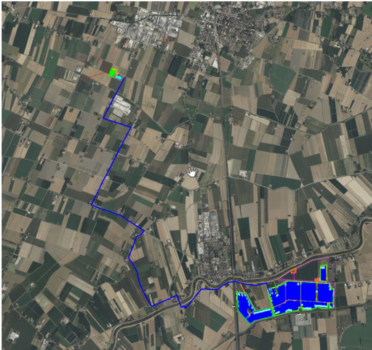
Figura 30 – Inquadramento su ortofoto dell'area di impianto, la linea del cavidotto di connessione AT (in blu), in ciano la stazione condivisa con altri operatori.
