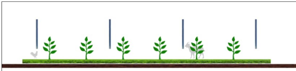
Figura 6: Sistema agrivoltaico in cui i moduli fotovoltaici sono disposti verticalmente. La coltivazione avviene tra le file dei moduli fotovoltaici, l'altezza minima dei moduli da terra influenza il possibile passaggio di animali (TIPO 3).
