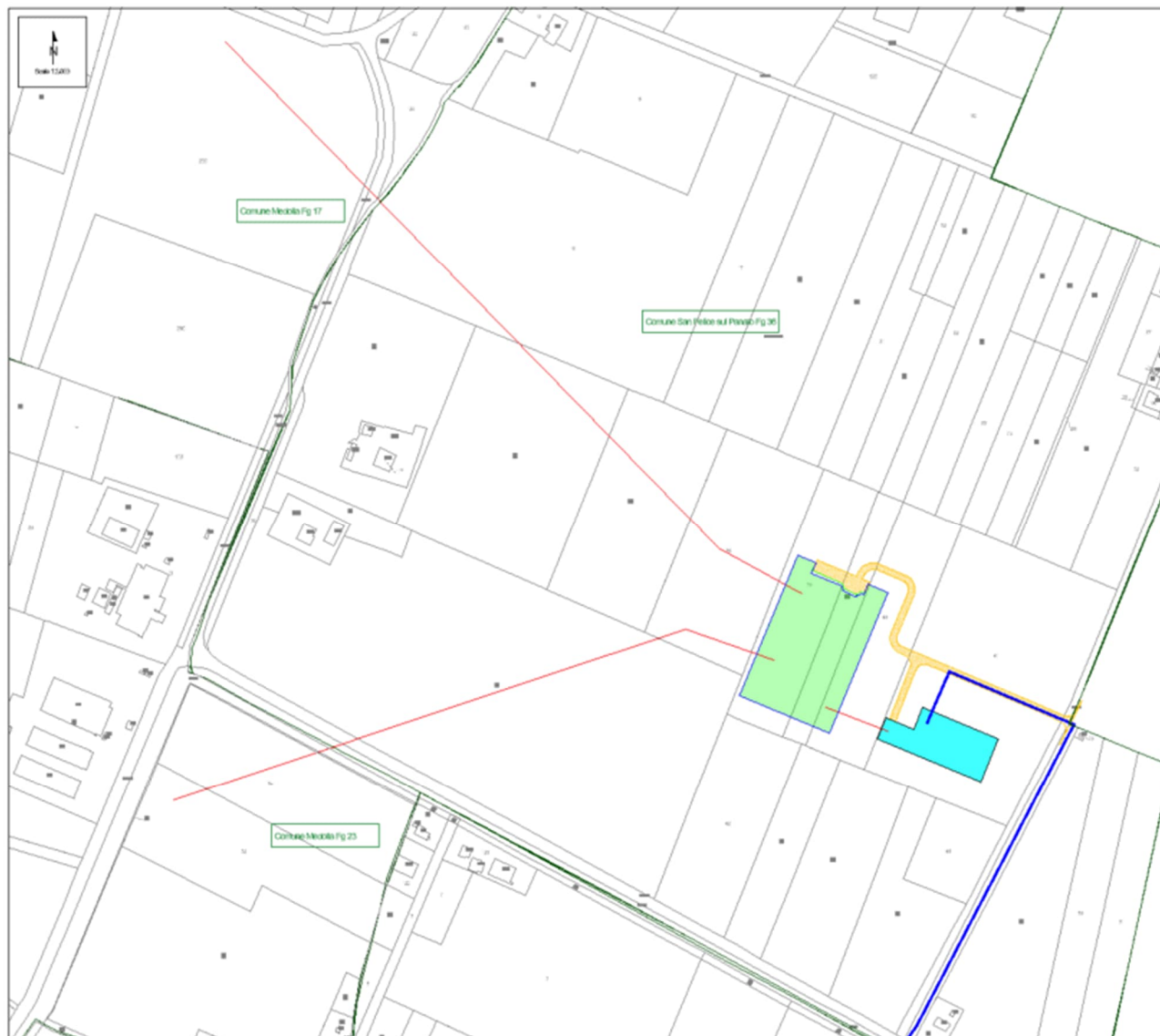
Figura 14: Tracciato connessione su carta catastale: tracciato interrato in rosso
