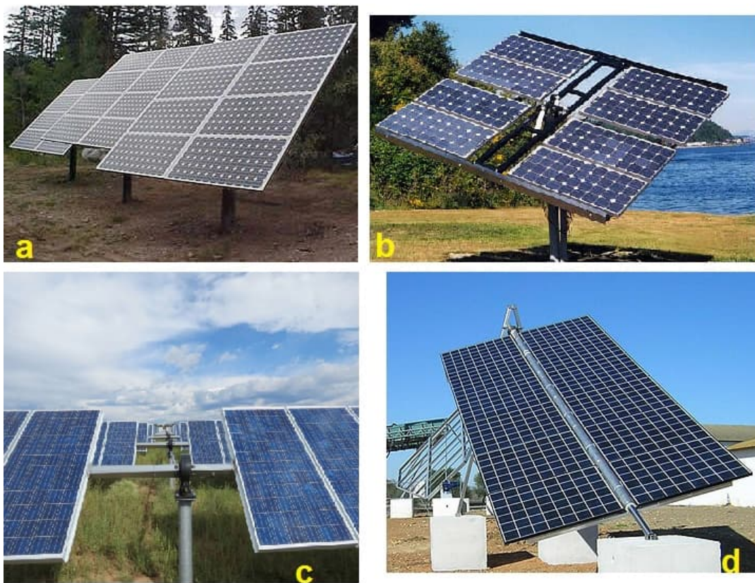
Figura 69: Sistemi ad inseguimento: a) inseguitore di tilt, b) inseguitore di azimut, c) inseguitore di rollio, d) inseguitore ad asse polare.
