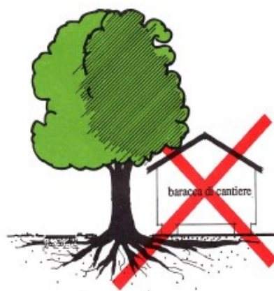
Fig 6 Divieto di occupazione del terreno in prossimità dell'albero
