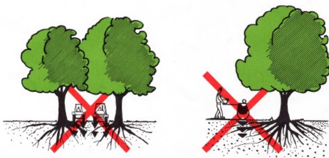
Fig. 2 Divieto di transito con mezzi pesanti all'interno delle aree di pertinenza delle alberature. Il costipamento del terreno porta alla morte dell'albero
