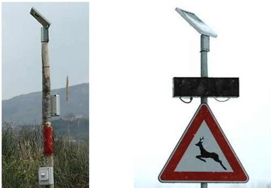
Figura 6-16 - Componenti utilizzati per l'impianto di Ponte Messa (RN): a sinistra sensore di movimento; a destra cartello verticale con lampeggianti. Entrambi i dispositivi sono alimentati da pannello solare.
