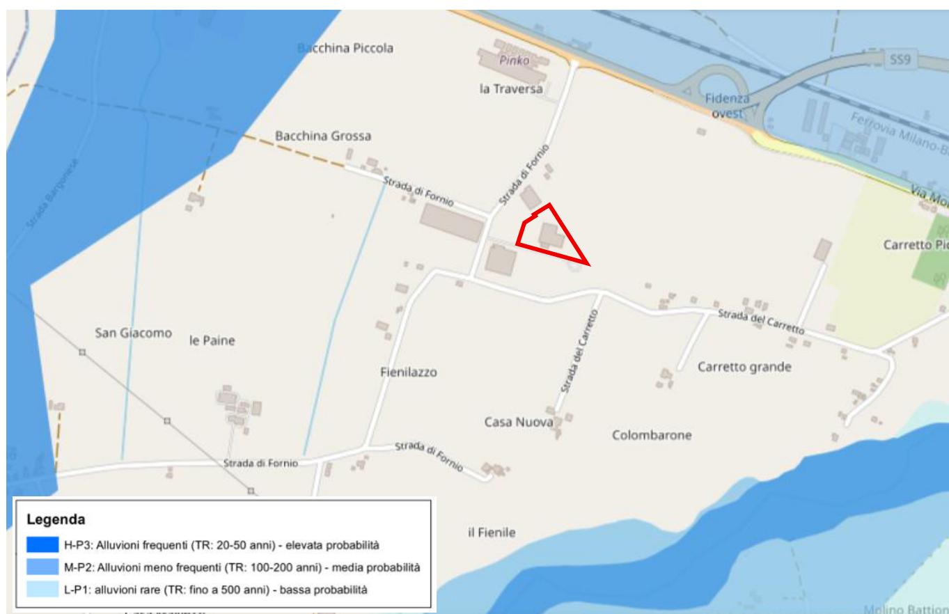
Figura 3.1.1 - Stralcio della Mappa della Pericolosità del Piano di Gestione del Rischio Alluvioni vigente; in rosso l'area interessata dalla ditta Val Parma Rottami S.r.l. (fuori scala).
