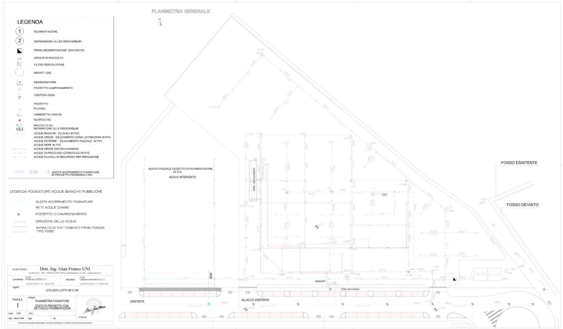
Figura 3.2.4 – Planimetria reti fognarie (a cura dell'Ing. Gian Franco Uni).
