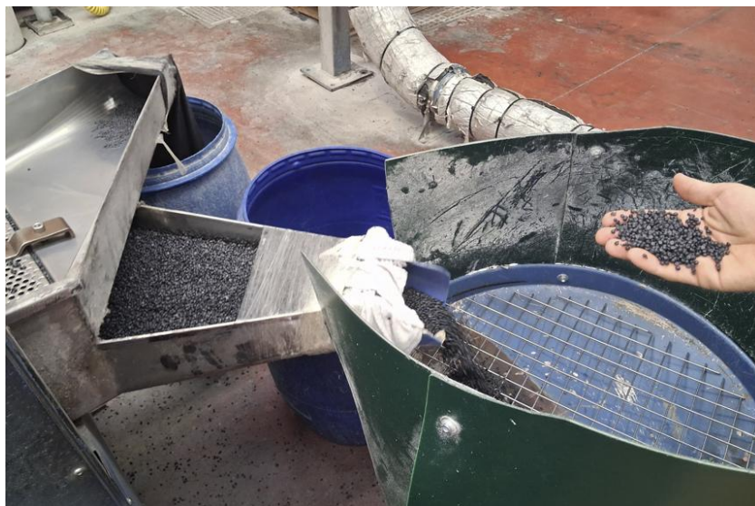
Foto 4 – prodotto ricondizionato e trasformato in granuli pronto per essere reimmesso nel ciclo di lavorazione dello stabilimento.
