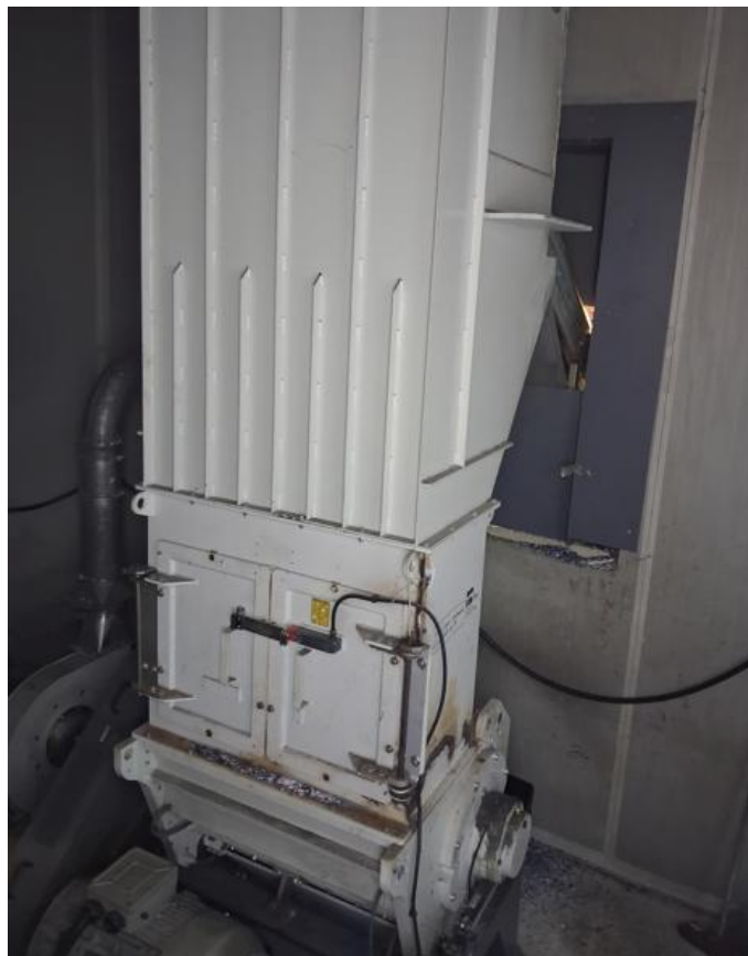
Foto 2 – mulino per la triturazione dei rifiuti plastici avviati poi a ricondizionamento per il riutilizzo completo.
