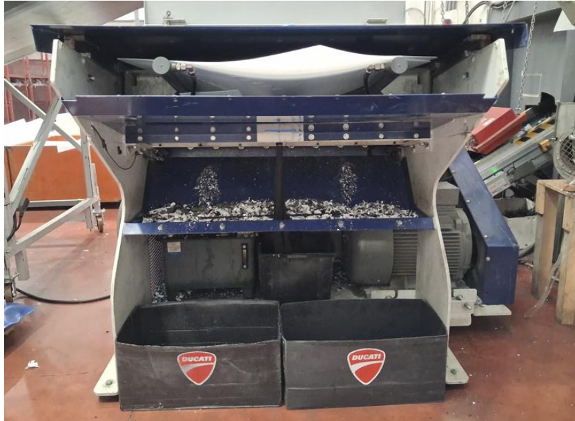
Foto 3 – materiale plastico triturato all'uscita del mulino
