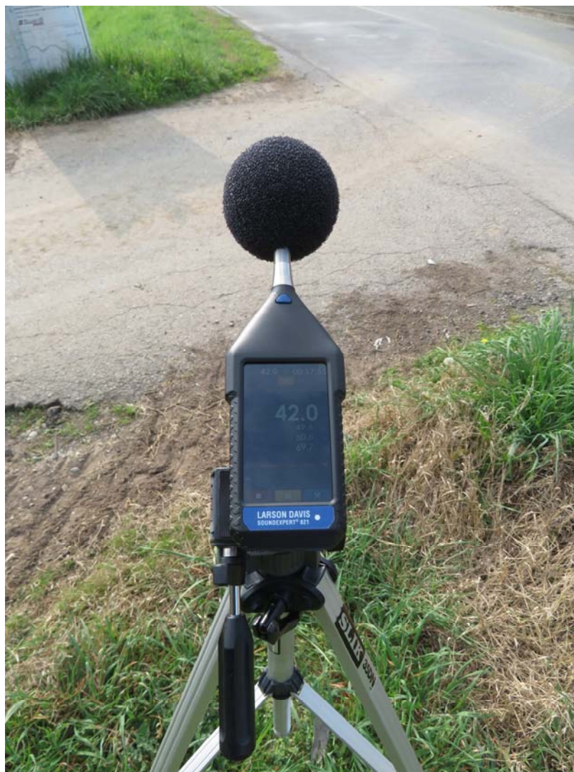
Foto n°1: Fonometro SoundExpert 821 in fase di misura
