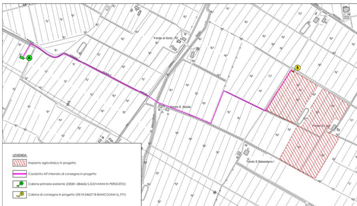
Fig. n° 17: Il tracciato dell'elettrodotto MT interrato
