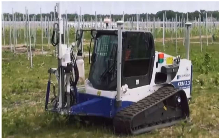
Figura 2 - Esempio di fissaggio delle strutture di supporto
