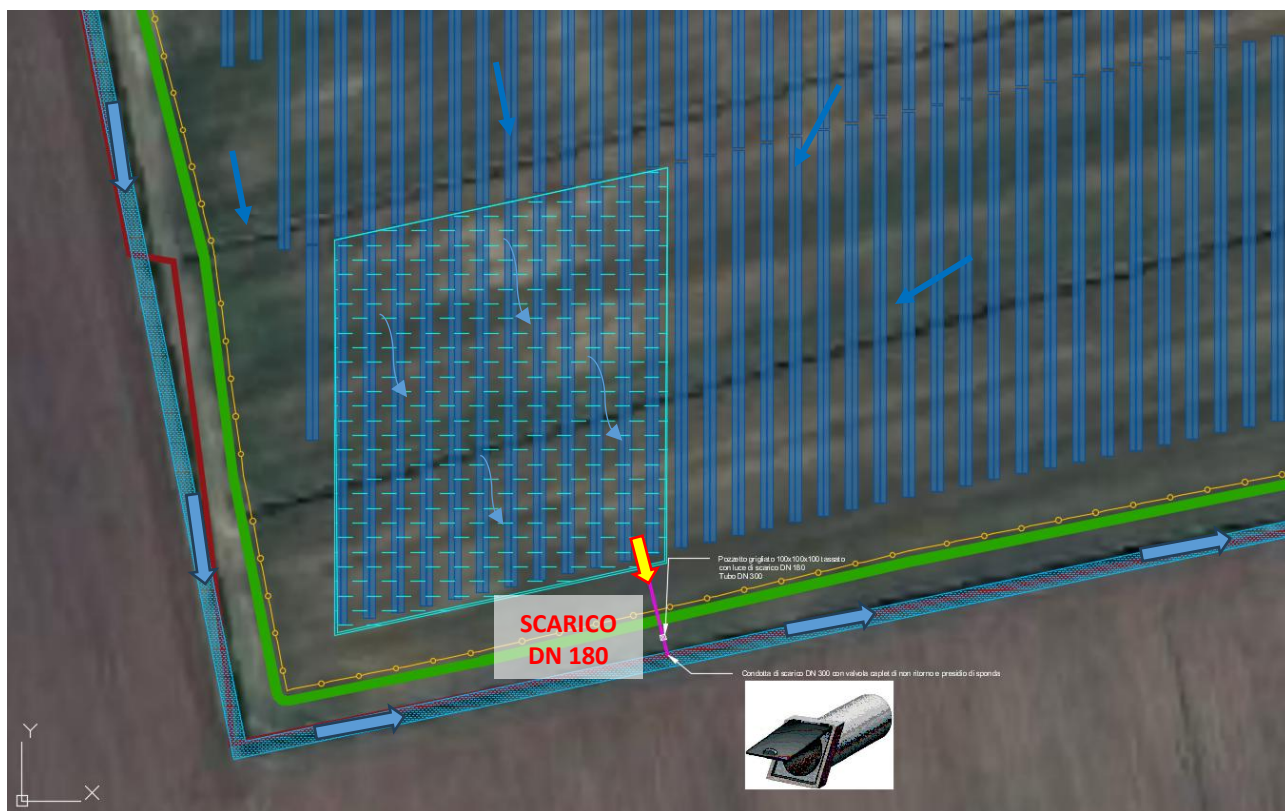
Figura 28 - Schema impianto drenaggio acque meteoriche sottocampo 2 – bacino 3
