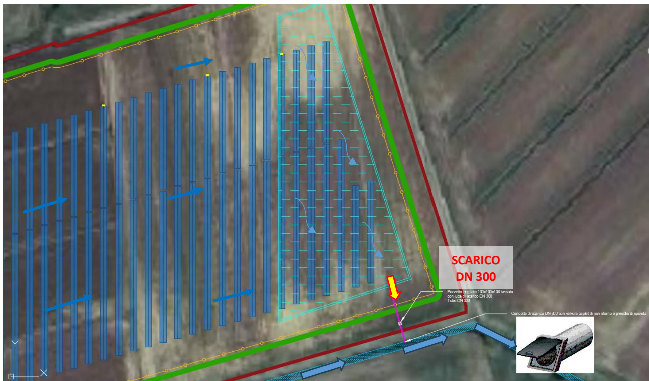
Figura 27 - Schema impianto drenaggio acque meteoriche sottocampo 1 – bacino 2
