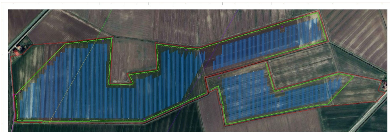
Figura 2: Layout di impianto FTV su base ortofoto; in rosso la superficie catastale disponibile, in verde le opere di mitigazione e in blu i pannelli FTV
